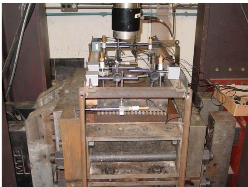
Figura 42. Caixa de cisalhamento instrumentada.
