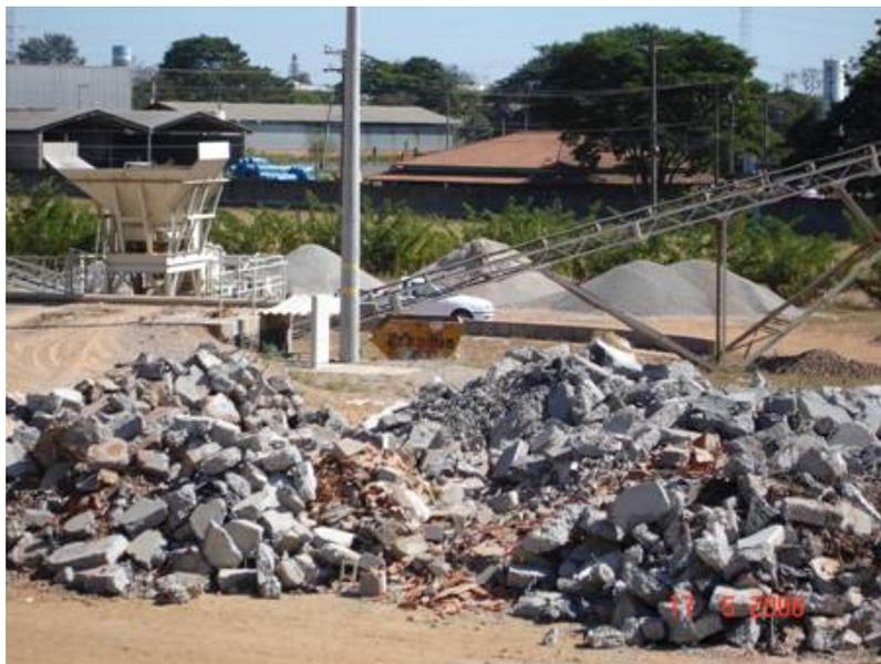
Figura 34. RCD - Material “cinza”.
