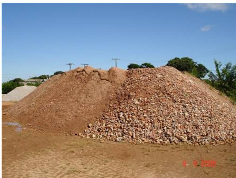
Figura 36. RCD-R – “Bica-corrída”.
