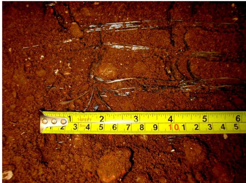
Figura 65. Ancoramento observado durante exumação da geogrelha submetida ao ensaio de arrancamento para o RCD-R05 aplicando-se uma sobrecarga de 50 kPa.
