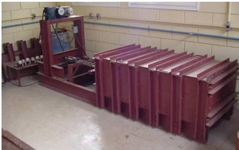
Figura 43. Equipamento de ensaio de arrancamento desenvolvido por Teixeira (1999).
