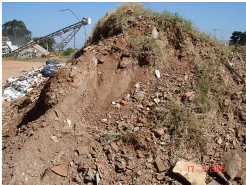
Figura 35. RCD – Material “misto”.
