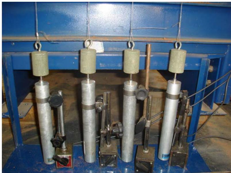
Figura 46. Instrumentação utilizada na medida dos deslocamentos.
