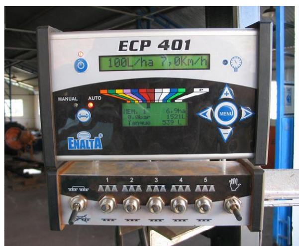
Figura 12. Controlador eletrônico de pulverização, no módulo Tela Principal, marca ENALTA, modelo ECP 401.
