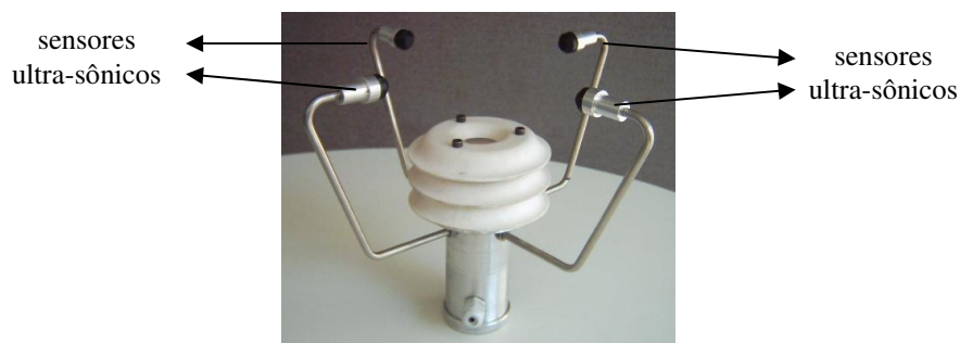
Figura 5. Posicionamento dos sensores ultra-sônicos num plano cartesiano.
