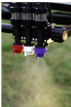
Figura 2. Aplicação em taxa variada pela vazão de múltiplos bicos.
