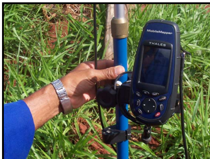
Figura 6. Receptor GPS Mobile Mapper CE Pós-Processado.
