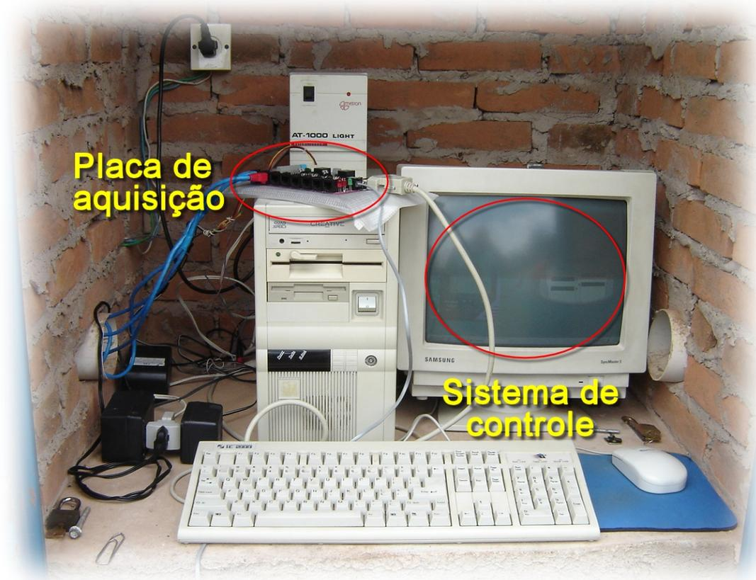
Figura 29: Interface de utilização do Controlador *Fuzzy* para condução racional da aeração
