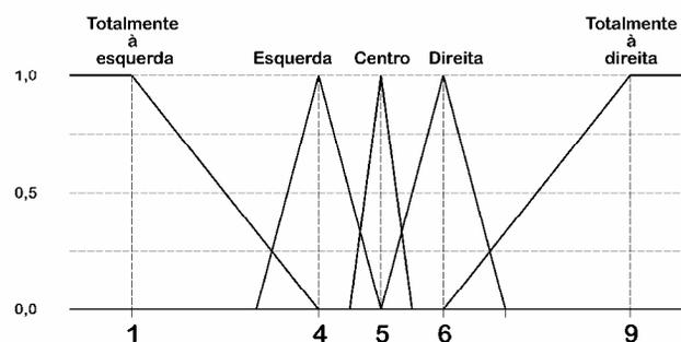
Figura 6: Variáveis e termos lingüísticos para a posição do veículo –  $x$  (m)
