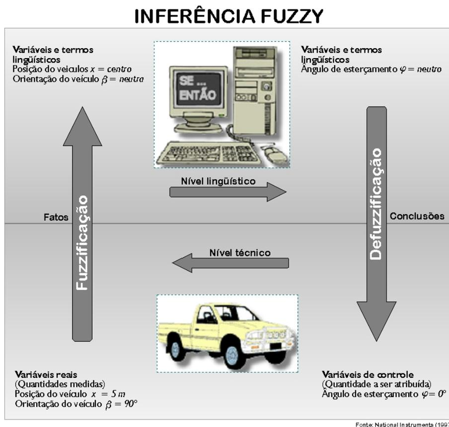
Figura 9: Estrutura completa de um controlador *Fuzzy*
