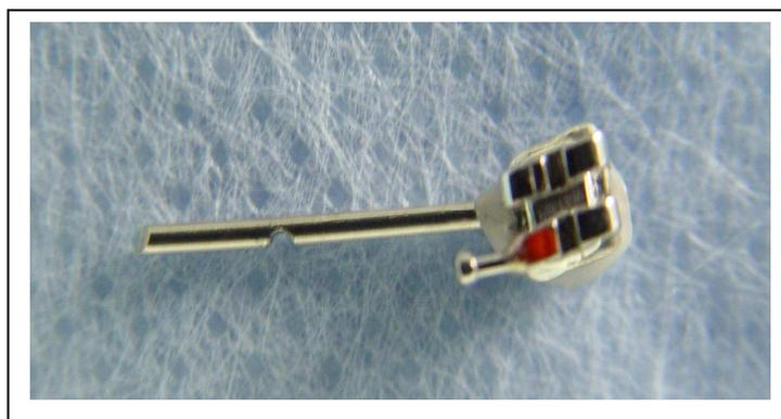
Figura 09 – Braquete teste com fio de 14 mm de comprimento e 1 mm de espessura, colado perpendicularmente a canaleta do braquete e canaleta confeccionada sobre o fio demonstrando o centro de resistência da raiz.
