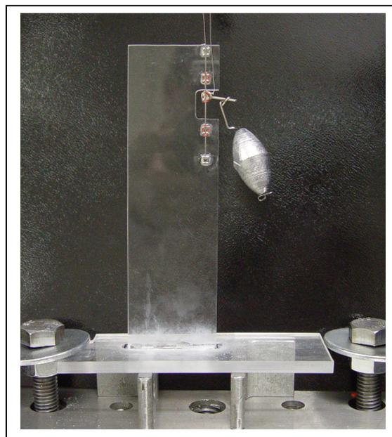
Figura 12 - Placa com o segmento de fio e o braquete teste que simulou o dente canino na mecânica de deslize, posicionada verticalmente para ajuste do amarrilho do braquete teste, na máquina de Ensaio Universal Emic –DL2000®.
