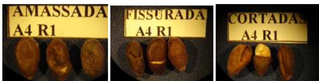
FIGURA 6. Danos mecânicos no lote 4.
