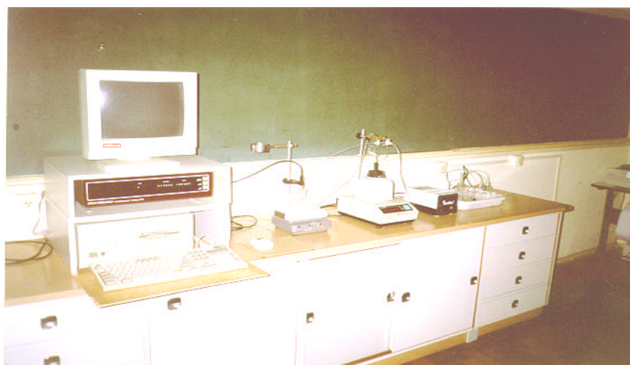
Figura 9. Sistema de titulação potenciométrica automatizado.
