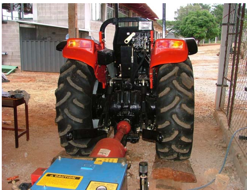
FIGURA 9 Dinamômetro acoplado na TDP do trator.
