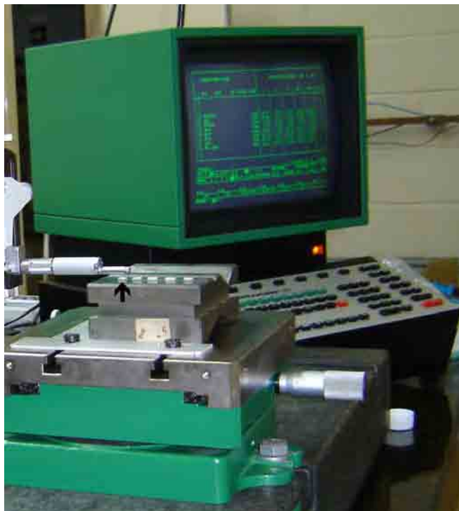
FIGURA 2 – Rugosímetro utilizado para a análise de rugosidade da superfície dos implantes densos (↑).
