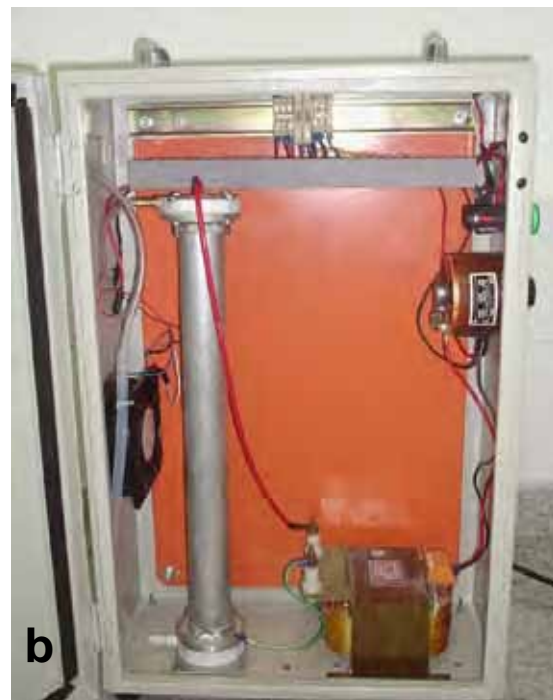
FIGURA 1 - Aparelho gerador de ozônio, desenvolvido no Instituto Tecnológico de Aeronáutica (ITA) Departamento de Física: a) aspecto externo do aparelho conectado ao tubo de vidro; b) aspecto interno do aparelho.
