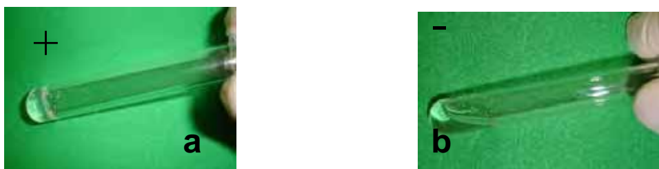
FIGURA 10 - a) Geleificação do lisado de amebócito de Limulus - presença de LPS. b) sem geleificação do lisado de amebócito de Limulus - ausência de LPS.
