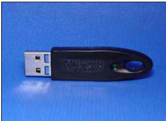
FIGURA 12 – Token, dispositivo para inserir assinatura digital.
