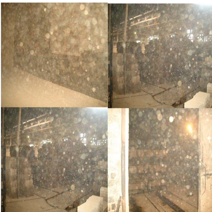
Figura 16. Partículas de argila soltas pelo ar em todo o galpão que funciona o processo produtivo das peças cerâmicas de uma das indústrias integrantes do APL do Município de Rio Verde de Mato Grosso, Mato Grosso do Sul
