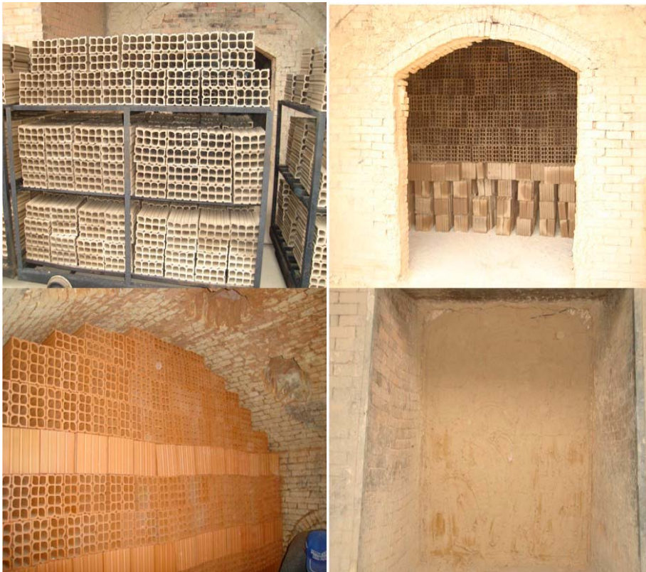
Figura 8. Etapas do processo produtivo do tijolo oito furos pelas indústrias integrantes do APL situado no Município de Rio Verde de Mato Grosso, Mato Grosso do Sul
