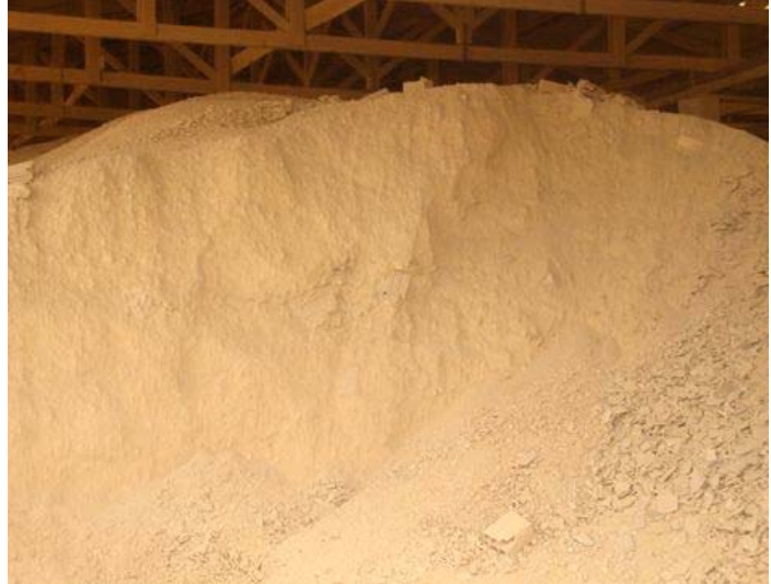
Figura 7. Argila peneirada e depositada em um galpão, fase em repouso a secagem artificial da argila estocada em um galpão coberto após ser moída e peneirada
