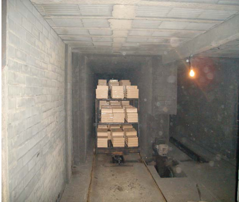
Figura 2. Secagem artificial em estufa (aproveitando gases quentes dos fornos de tijolos oito furos do pólo cerâmico de Rio Verde de Mato Grosso, Mato Grosso do Sul)
