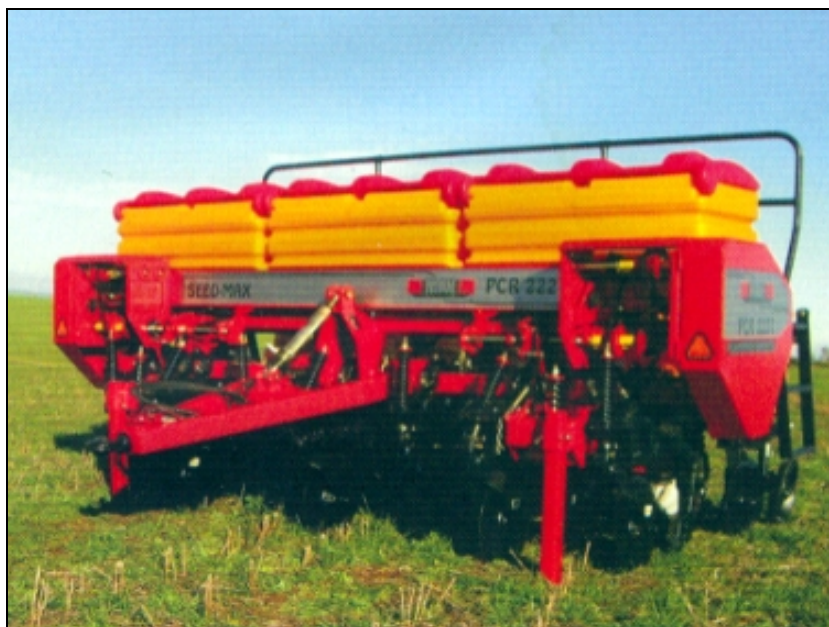
Figura 8 – Semeadora-adubadora de semeadura direta MAX Seed-Max PCR 2226.
