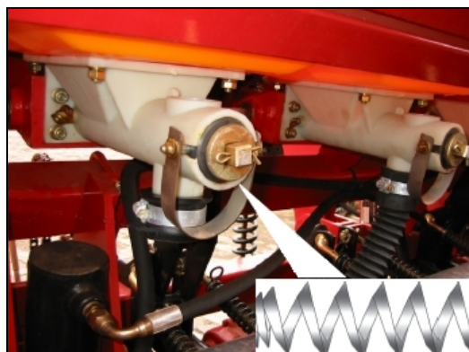
Figura 2 – Mecanismo dosador de adubo do tipo helicoidal.
