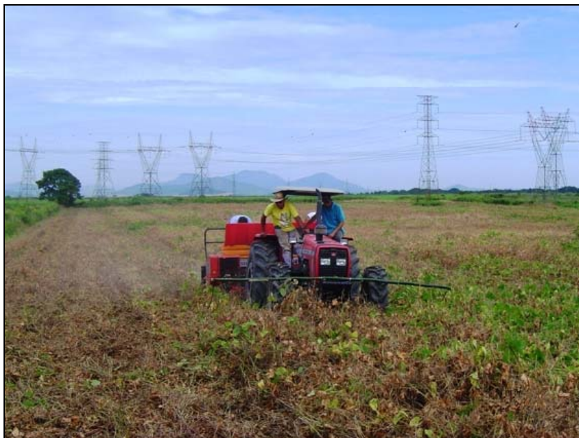
Figura 7 – Avaliação da semeadora-adubadora na semeadura de sorgo em sistema de semeadura direta.
