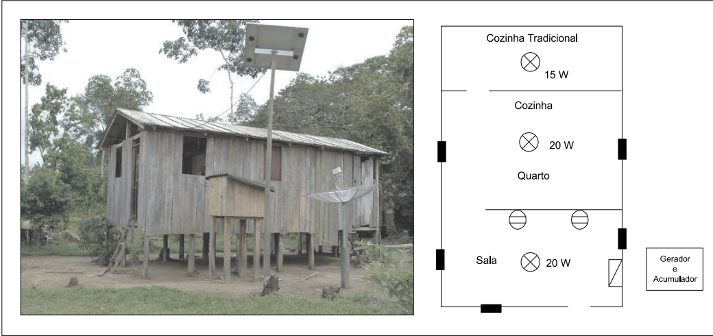
Figura 2.32: Vista externa do SFD2 e planta aproximada do domicílio.
