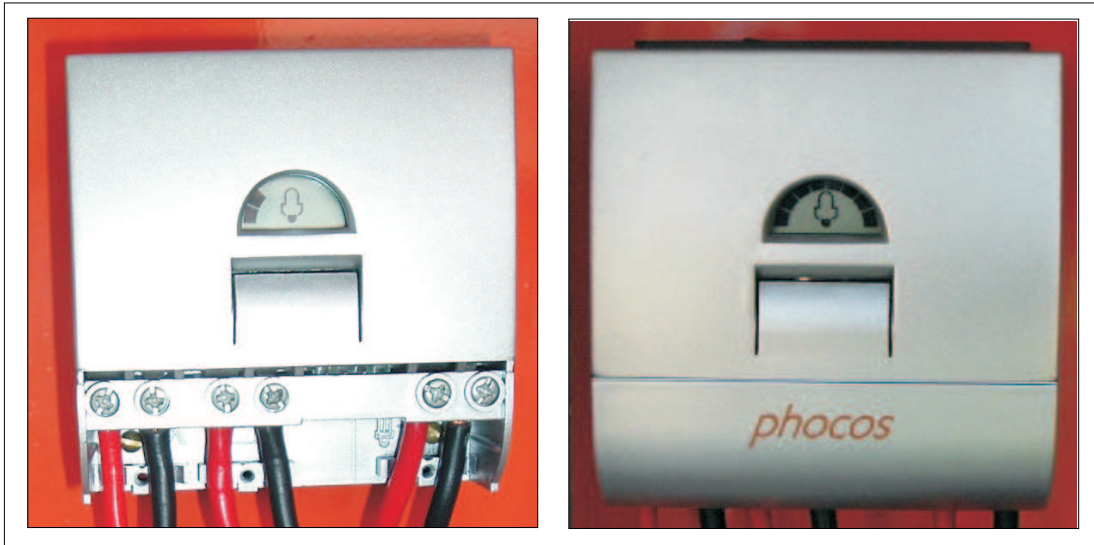
Figura 3.2: Controlador de carga e descarga indicando estado de carga da bateria.
