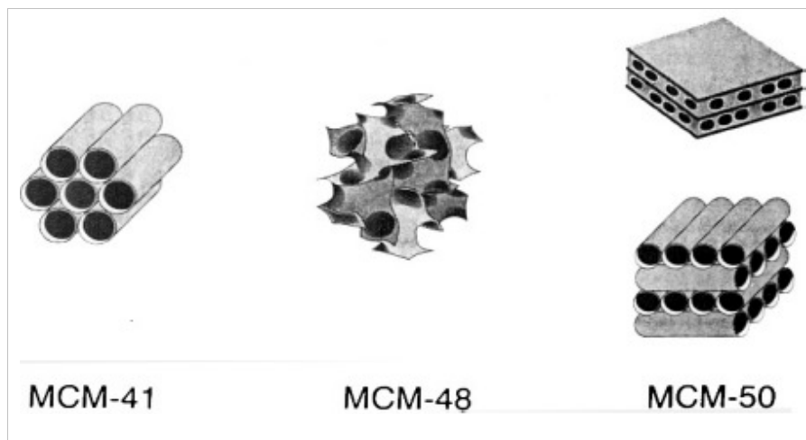
Figura 1.4 – Representação da família M41S (MCM-41: fase hexagonal, MCM-48: fase cúbica e MCM-50: fase lamelar).
