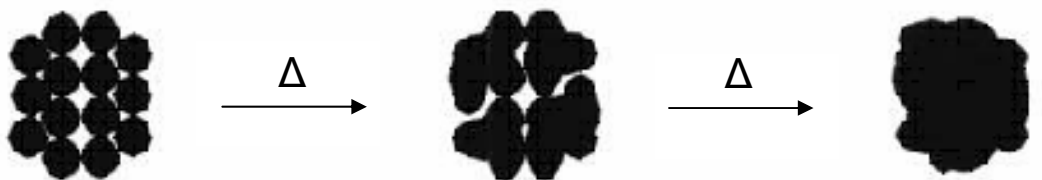
Figura 7: Ilustração do processo de sinterização de partículas metálicas [31].
