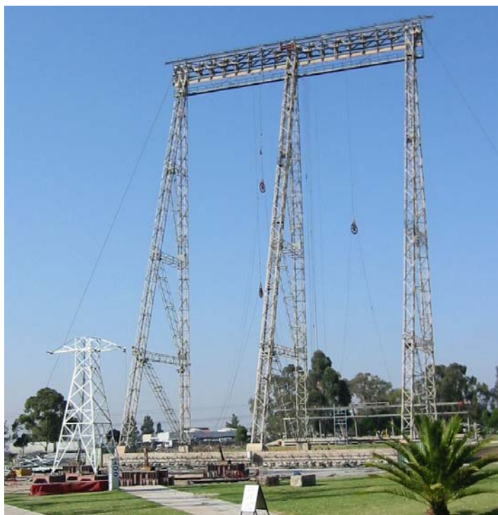
Figura 6.1: Pórticos da estação de testes da empresa ESKOM Transmission Group e a torre “1”.
