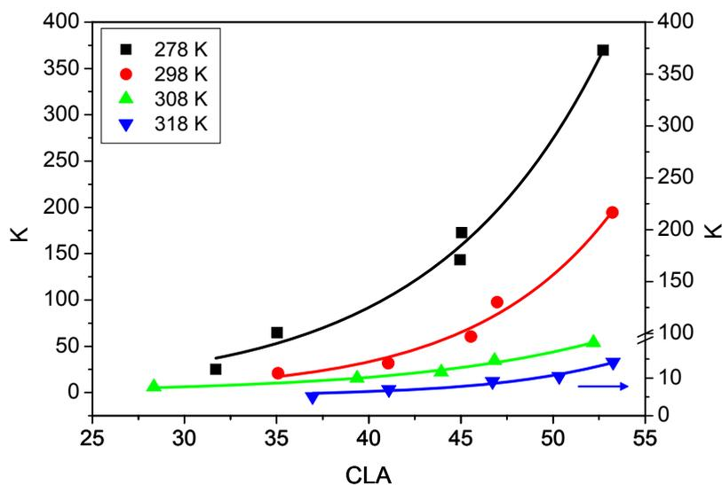
**Figura 16.** Coeficiente de partição para o ânion [Mn(CN)<sub>5</sub>NO]<sup>3-</sup> em função do CLA. SAB PEO4000/Li<sub>2</sub>SO<sub>4</sub>/H<sub>2</sub>O nas temperaturas: 278 K (■), 298 K (●), 308 K (▲) e 318 K (▼).
