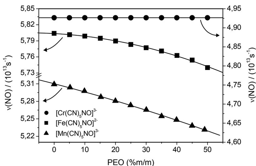
**Figura 33.** Efeito da concentração de PEO sobre a frequência de estiramento do grupo NO, para os ânions  $[\text{Cr}(\text{CN})_5\text{NO}]^{3-}$  (●),  $[\text{Fe}(\text{CN})_5\text{NO}]^{2-}$  (■) e  $[\text{Mn}(\text{CN})_5\text{NO}]^{3-}$  (▲), a 25 °C.
