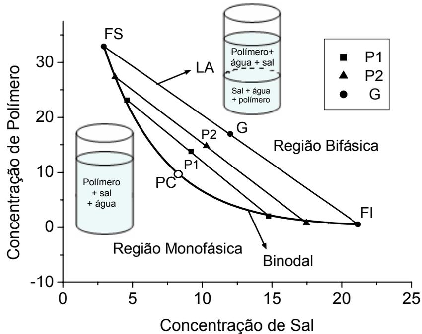
**Figura 01.** Diagrama de fase esquemático de um sistema aquoso bifásico.
