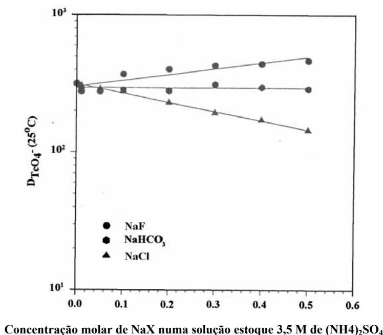
**Figura 06.** Gráfico da razão de partição versus a concentração molar de NaF, NaCl, e NaHCO<sub>3</sub> na solução estoque 3,5 M (NH<sub>4</sub>)<sub>2</sub>SO<sub>4</sub> usada para preparar o SAB com 40% de PEO 2000. Extraído da ref. [32].
