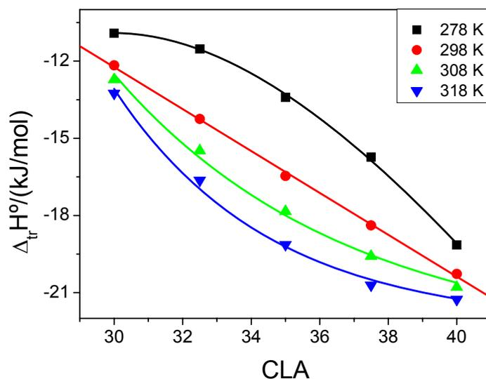
**Figura 21.**  $\Delta_{tr}H^\circ$  versus CLA para o ânion complexo  $[\text{Mn}(\text{CN})_5\text{NO}]^{3-}$  em SAB's PEO4000/ $\text{Na}_2\text{SO}_4/\text{H}_2\text{O}$  em diferentes temperaturas: 278 K (■), 298 K (●), 308 K (▲) e 318 K (▼).
