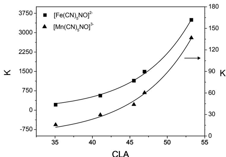
**Figura 29.** Coeficiente de partição versus CLA para os ânions complexos  $[\text{Fe}(\text{CN})_5\text{NO}]^{2-}$  (■) ref. [48] e  $[\text{Mn}(\text{CN})_5\text{NO}]^{3-}$  (▲), no SAB formado por  $\text{Li}_2\text{SO}_4$  e PEO 4000 na temperatura de 298 K.
