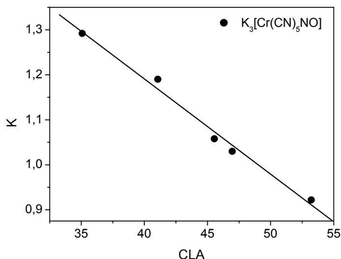
**Figura 30.** Coeficiente de partição versus CLA para o ânion complexo  $[\text{Cr}(\text{CN})_5\text{NO}]^{3-}$  (●) ref. [48], no SAB formado por  $\text{Li}_2\text{SO}_4$  e PEO4000 na temperatura de 25 °C.
