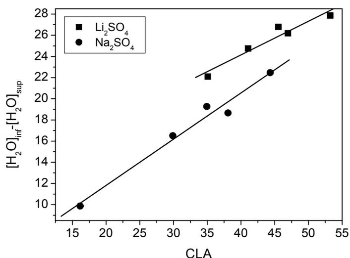
**Figura 31.** Diferença de concentração % (massa) de água nas fases inferior e superior em função do CLA nos SAB's: PEO4000/Li<sub>2</sub>SO<sub>4</sub>/H<sub>2</sub>O (■) e PEO4000/Na<sub>2</sub>SO<sub>4</sub>/H<sub>2</sub>O (●), a 25 °C.
