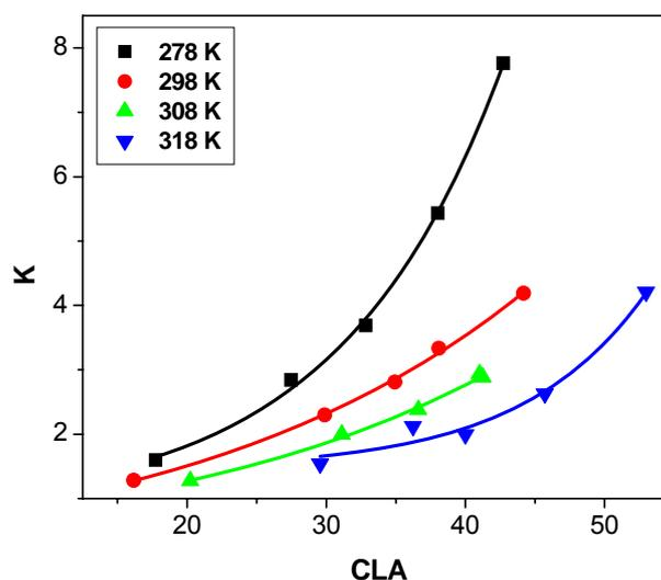
**Figura 17.** Coeficiente de partição para o  $[\text{Mn}(\text{CN})_5\text{NO}]^{3-}$  em função do CLA nos SAB's PEO4000/ $\text{Na}_2\text{SO}_4/\text{H}_2\text{O}$  nas temperaturas: 278 K (■), 298 K (●), 308 K (▲) e 318 K (▼).
