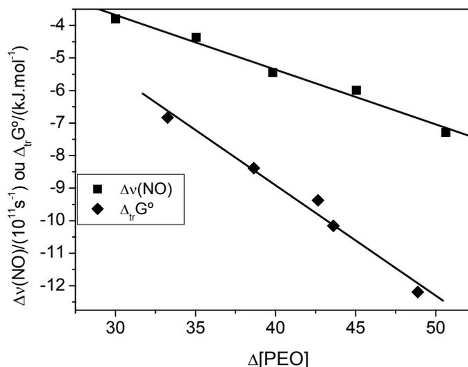
**Figura 15.**  $\Delta_{tr}G^\circ$  (◆) e  $\Delta v(\text{NO})$  (■) como uma função da diferença de concentração de PEO entre as fases superior e inferior para o SAB formado por PEO 4000/ $\text{Li}_2\text{SO}_4/\text{H}_2\text{O}$  a 25°C.
