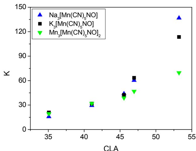
**Figura 26.** Coeficiente de partição para o ânion  $[\text{Mn}(\text{CN})_5\text{NO}]^{3-}$  com diferentes contra-íons:  $\text{Na}^+$  ( $\blacktriangle$ ),  $\text{K}^+$  ( $\blacksquare$ ),  $\text{Mn}^{2+}$  ( $\blacktriangledown$ ), em função do CLA nos SAB's PEO4000/ $\text{Li}_2\text{SO}_4/\text{H}_2\text{O}$  a 25 °C.
