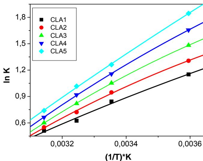
**Figura 19.**  $\ln K$  versus  $1/T$  para o ânion complexo  $[\text{Mn}(\text{CN})_5\text{NO}]^{3-}$  em SAB's PEO4000/ $\text{Na}_2\text{SO}_4/\text{H}_2\text{O}$  em diferentes valores de CLA: 30 (■), 32,5 (●), 35 (▲), 37,5 (▼) e 40 (◆).
