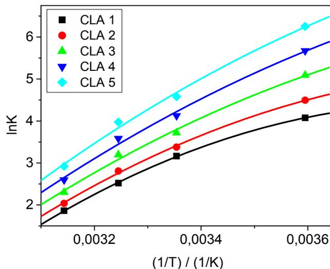
**Figura 18.**  $\ln K$  versus  $1/T$  para o ânion complexo  $[\text{Mn}(\text{CN})_5\text{NO}]^{3-}$  em SAB's PEO4000/ $\text{Li}_2\text{SO}_4/\text{H}_2\text{O}$  em diferentes valores de CLA: 37 (■), 40 (●), 44 (▲), 48 (▼) e 52 (◆).
