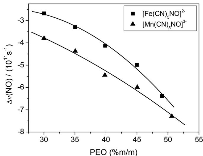
**Figura 34.** Variação da freqüência de estiramento do grupo NO em função da concentração de PEO para os complexos  $[\text{Fe}(\text{CN})_5\text{NO}]^{2-}$  (■) e  $[\text{Mn}(\text{CN})_5\text{NO}]^{3-}$  (▲) a 25 °C.
