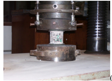
Figura 40: (a) marcação e numeração dos furos nas vigas, (b) equipamento de extração, (c) vigas furadas, (d) testemunhos, (e) capeamento dos testemunhos, (f) ensaio de ruptura à compressão.
