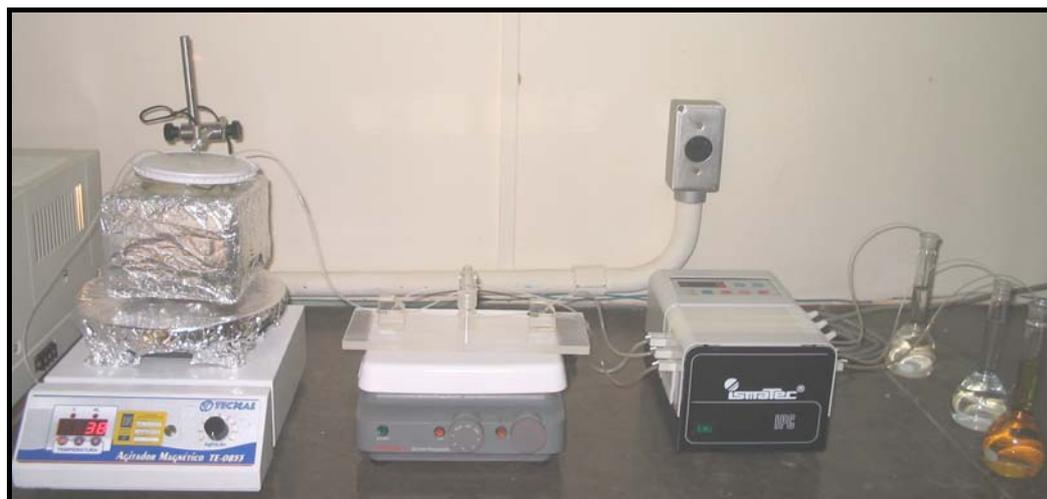
Figura 12. Sistema utilizado para reação de 1,2 naftoquinona-4-sulfonato de sódio (NQS) com aminoácidos em pH 10.
