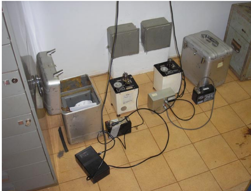
Figura 3.17: Gravímetros em período de aquecimento no Labtopo UNICAMP. Fonte: Foto do autor.
