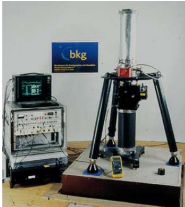
Figura 3.13: Gravimetro absoluto JILAG-3. Fonte: (FAGGION, 2006).
