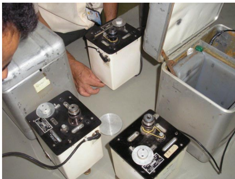
Figura 4.18: Gravímetro LaCoste & Romberg. Fonte: Foto do autor.
