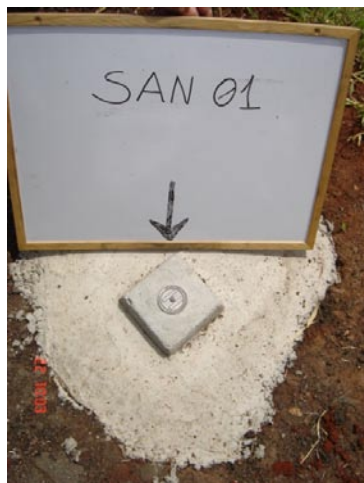
Figura 1.1: Marco de concreto SAN01.
