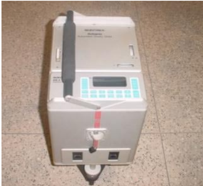
Figura 3.11: Gravímetro digital Scintrex CG-3. Fonte: (SATO, 2004).
