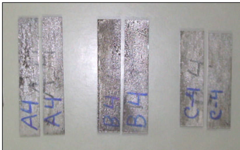
Figura 4.1.2 – Amostras laminadas a quente e solubilizadas a 950 °C por 45 minutos após corte (15x70mm).
