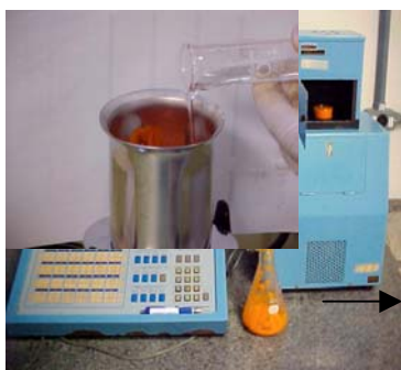
Figura 3.3 Etapas de preparo das amostras para análise da cor (L, a, b) no sistema Hunter em pimentas “ in natura ” e em conserva
