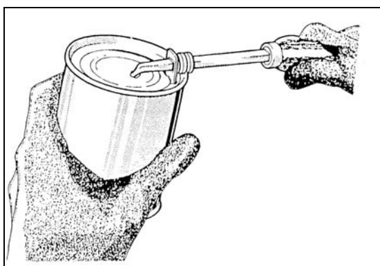
FIGURA 3.23. Remoção da tampa com o uso do abridor de latas especial.
