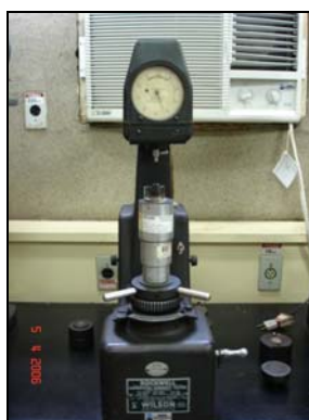
FIGURA 3.2. Durômetro Wilson para ensaio de dureza Rockwell HR15T.
