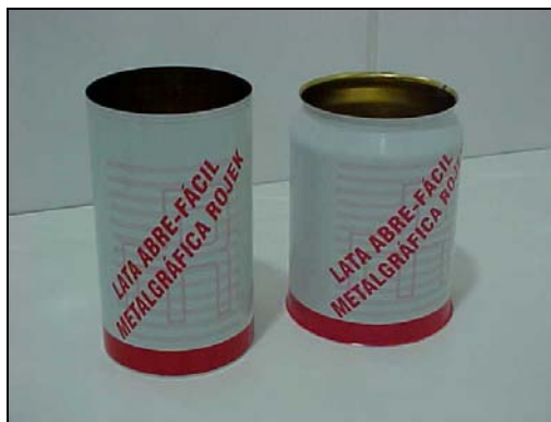
FIGURA 2.20. Lata antes e após o Processo Stretching de expansão.
