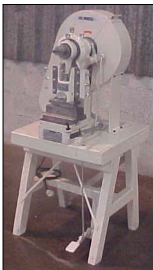
FIGURA 3.3. Prensa para corte de corpos-de-prova para ensaio de tração.
