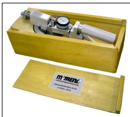
FIGURA 3.14. Dispositivo para aferição do diâmetro interno da lata.
