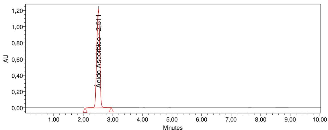
Figura 10. Cromatograma obtido po CLAE para mistura de suco de acerola verde e maltodextrina. Condições cromatográficas: coluna Hypersil ODS-2 (5  $\mu$ m, 15 cm x 4,6 mm); fase móvel (A) ácido fórmico 0,1% em água (99%) e (B) ácido fórmico 0,1% em ACN (1%); fluxo de 1,0 mL/min.
