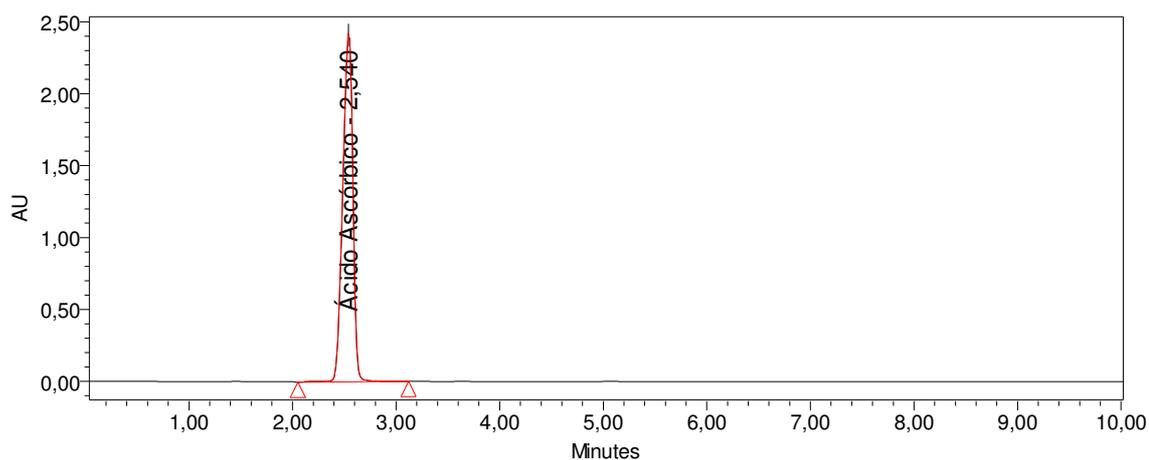
Figura 9. Cromatograma obtido po CLAE para o suco de acerola verde. Condições cromatográficas: coluna Hypersil ODS-2 (5  $\mu$ m, 15 cm x 4,6 mm); fase móvel (A) ácido fórmico 0,1% em água (99%) e (B) ácido fórmico 0,1% em ACN (1%); fluxo de 1,0 mL/min.
