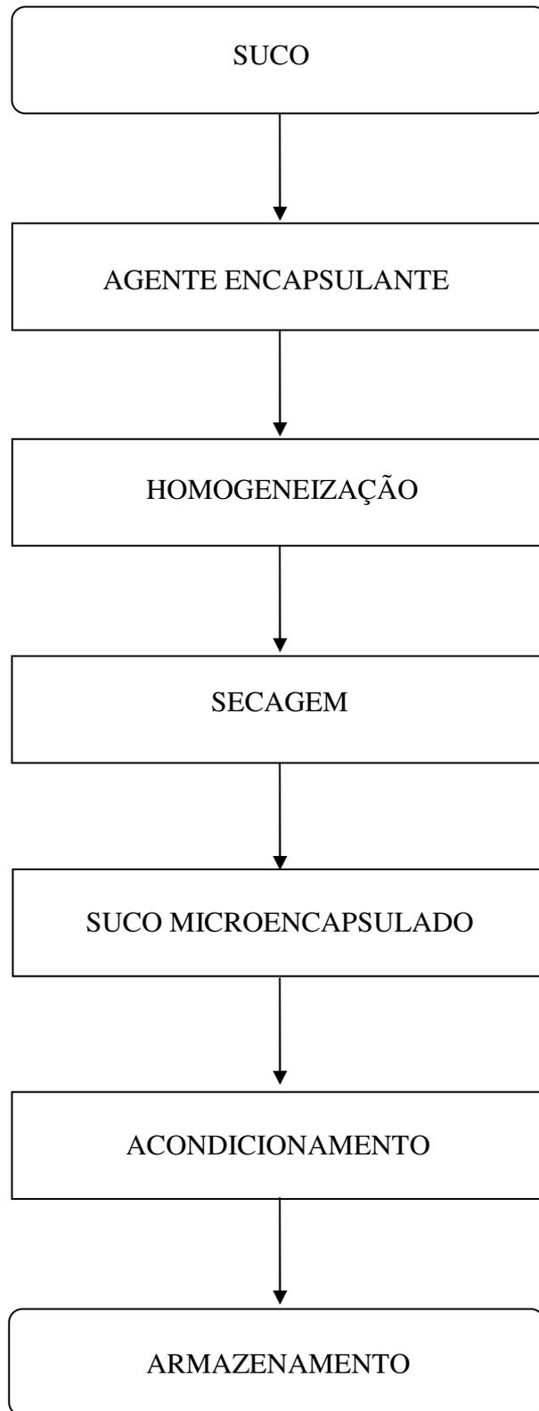
Figura 6. Fluxograma de processamento do suco de acerola microencapsulado
