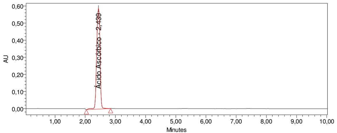
Figura 11. Cromatograma obtido po CLAE para suco microencapsulado. Condições cromatográficas: coluna Hypersil ODS-2 (5  $\mu$ m, 15 cm x 4,6 mm); fase móvel (A) ácido fórmico 0,1% em água (99%) e (B) ácido fórmico 0,1% em ACN (1%); fluxo de 1,0 mL/min.
