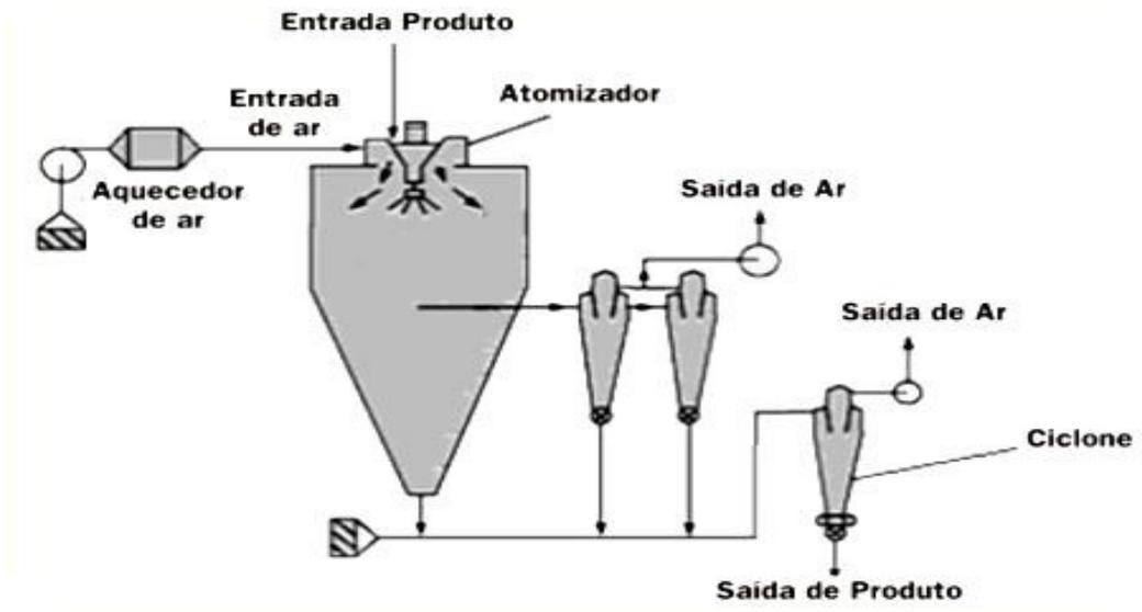
Figura 3. Esquema de funcionamento de *spray dryer*
