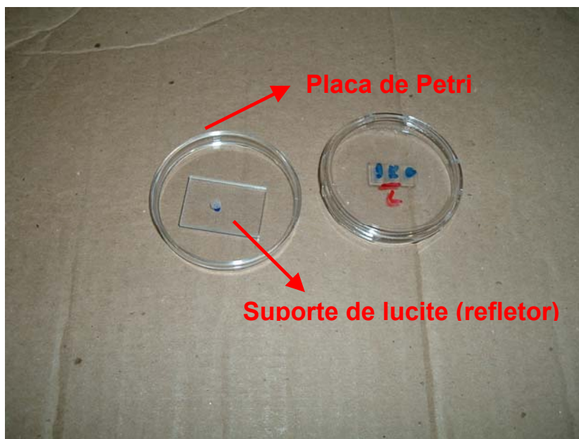
Figura 5.16 – Suporte de lucite utilizado para a deposição da amostra, acondicionado em Placas de Petri para armazenamento e transporte.
