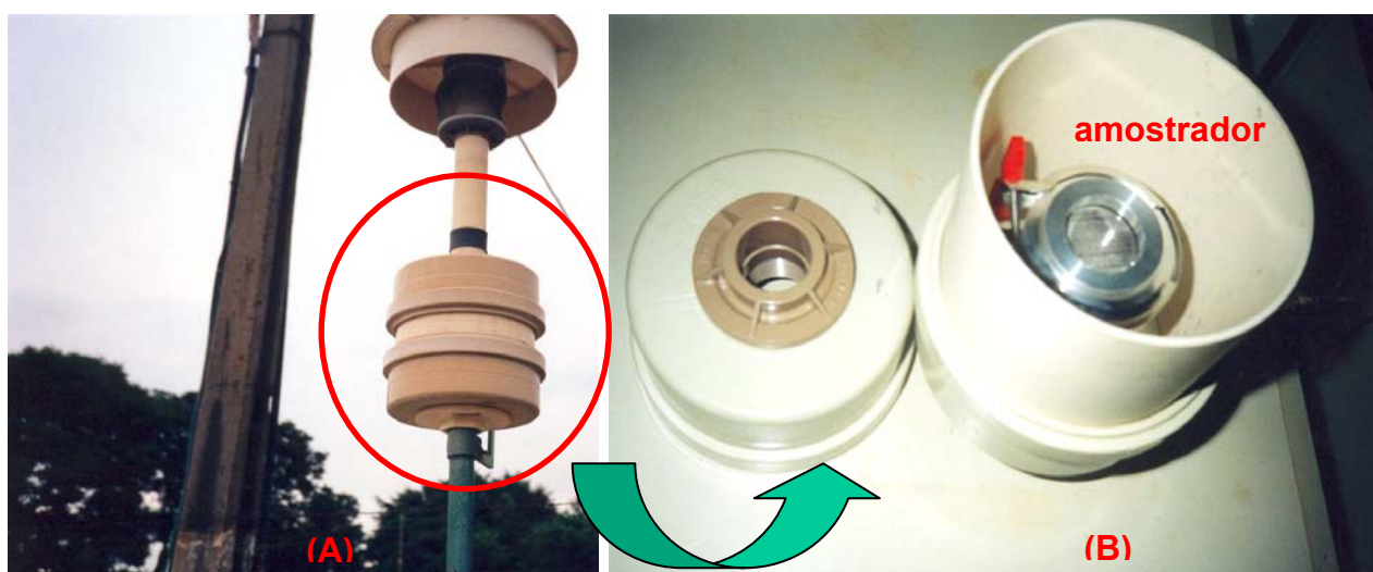
Figura 5.6 – Vista externa da torre do amostrador (A). Em B pode-se observar o amostrador instalado dentro do receptáculo da torre.
