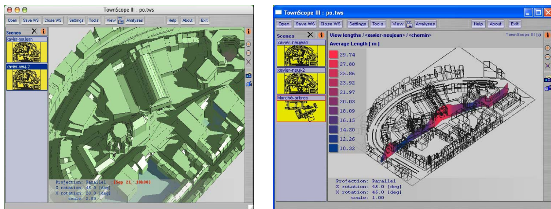
Fig. 64 e 65. Sombras em vista paralela e resultados de polyline, comprimentos de vista em 3D. Fonte: Townscope III
