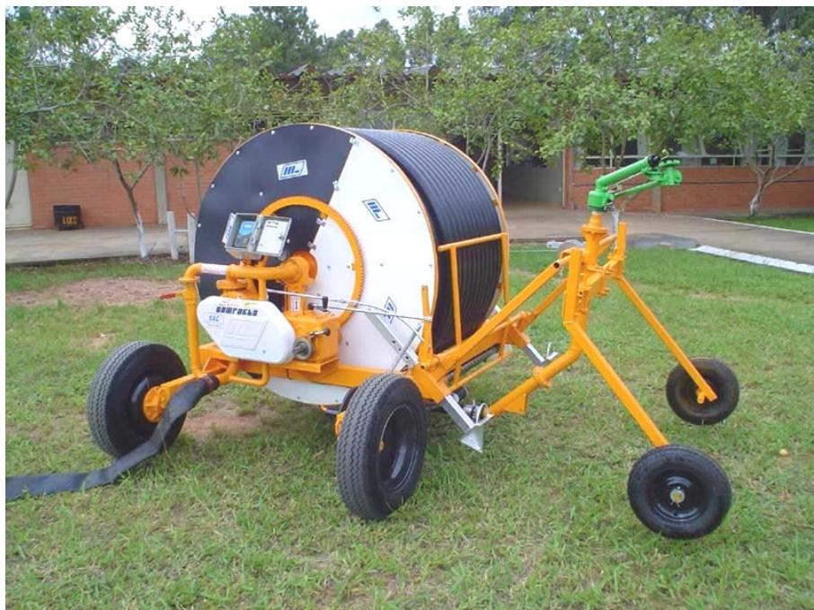
**FIGURA 4.** Sistema de irrigação autopropelido usado nos ensaios. CEFET, Uberaba, MG, 2006.
