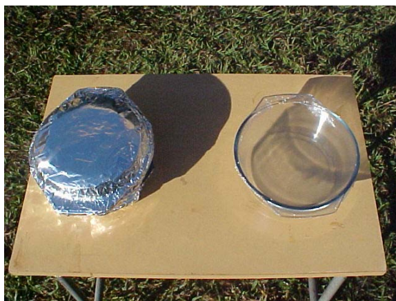
Figura 9. Exposição e irradiação das amostras de água residual sob luz solar.
