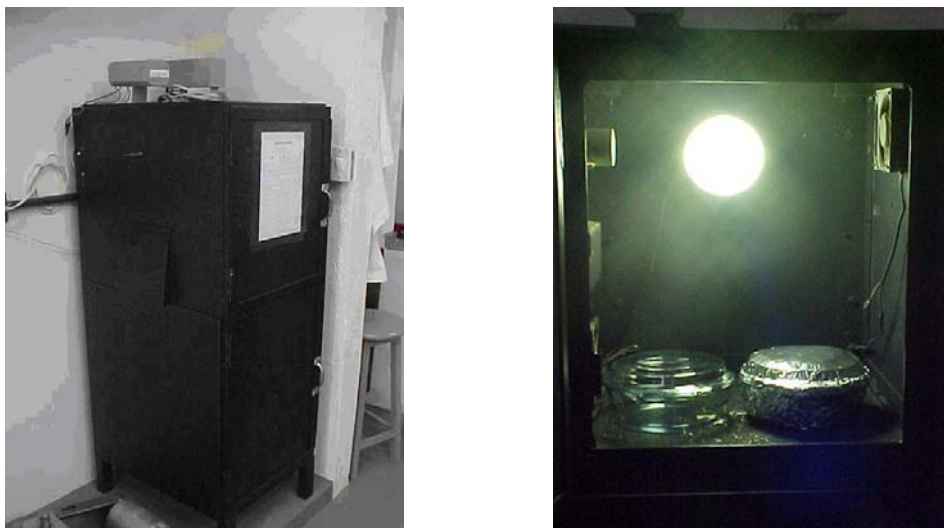
Figura 11. Exposição das amostras à lâmpada a vapor de mercúrio.
