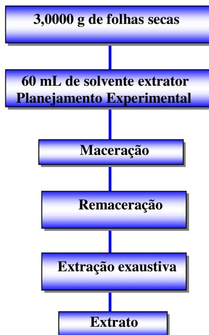
**Figura 7**-Seqüência do procedimento para o preparo dos extratos para a escolha do solvente extrator.
