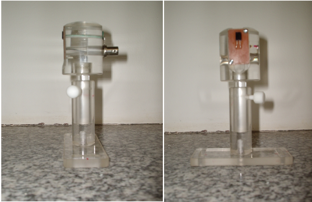
Figura 31 - À esquerda, vista frontal da base de acrílico e do suporte do fotodiodo; à direita vista lateral do suporte para o conector BNC.
