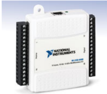
Figura 34 – Placa USB multifuncional de aquisição de dados. (Fonte: National Instruments®)
