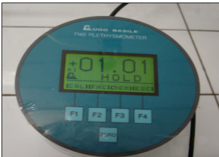
Figura 4 - Imagem do aparelho de plestimografia (Plethysmometer-Ugo Basile®, Itália), que faz a leitura do volume da pata.
