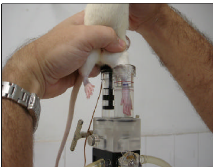
Figura 5 - Imagem do início da introdução da pata para fazer a medida volumétrica da pata, com a marca feita na articulação tarsiana para termos como base para realização das medidas.
