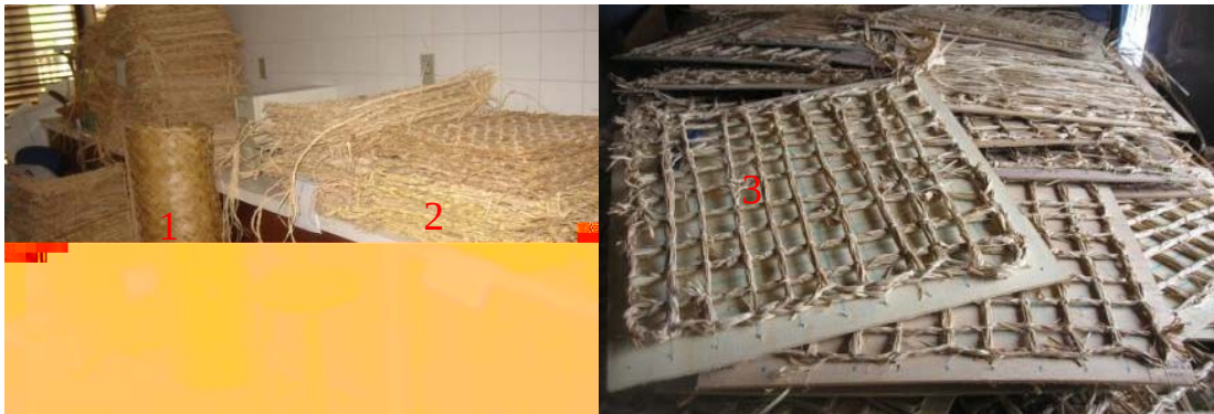
FIGURA 23 – Tipos de geotêxteis produzidos artesanalmente com: (1) fibras de babaçu; (2) fibras de tucum; (3) fibras de buriti
