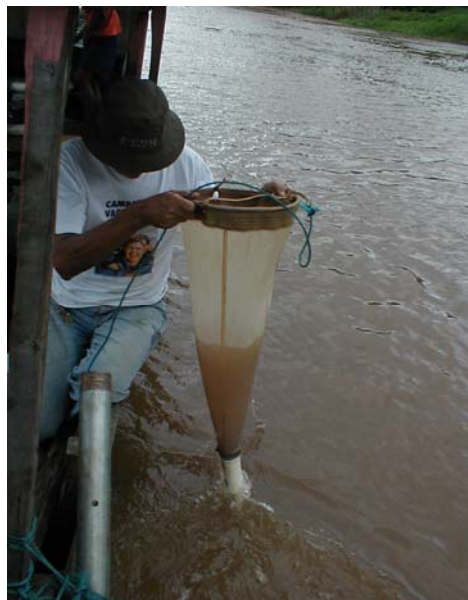
FIGURA 9 – Rio Mearim no período chuvoso (maio/2005). No detalhe o recolhimento de rede de arraste para coleta de MPS em barco motorizado.
