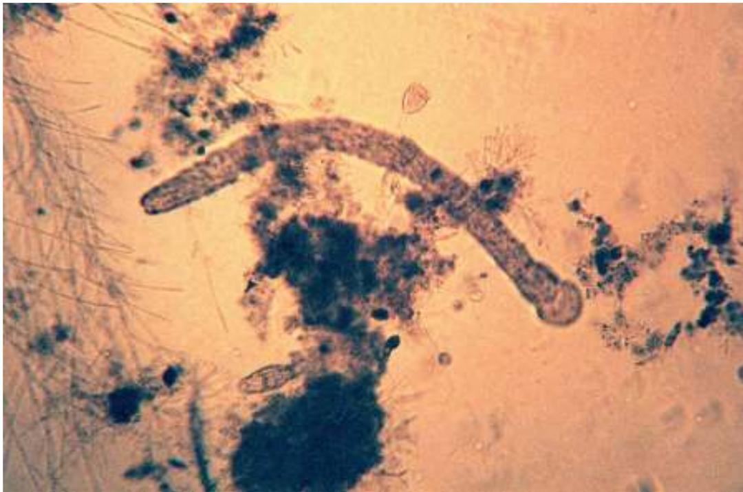
Figura 5.73: Reator  $\theta$ c 7EP: Protozoário do grupo dos Ciliados Fixos, Micrometazoário do grupo dos Anelídeos, Bactérias Filamentosas.
