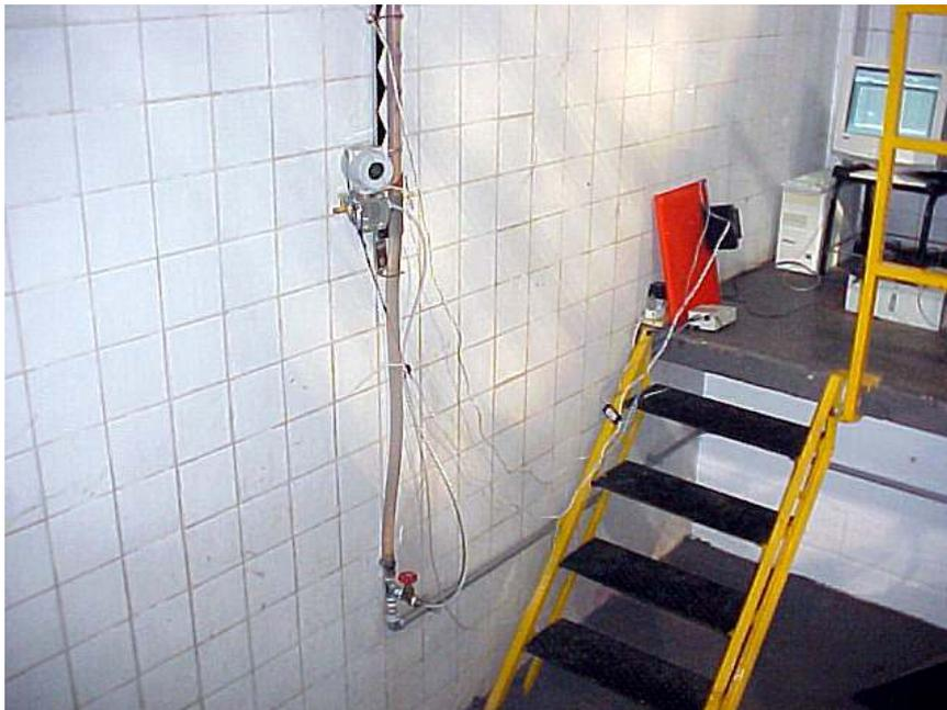
Figura 4.6 – Aquisição dos dados de nível da caixa de sucção
