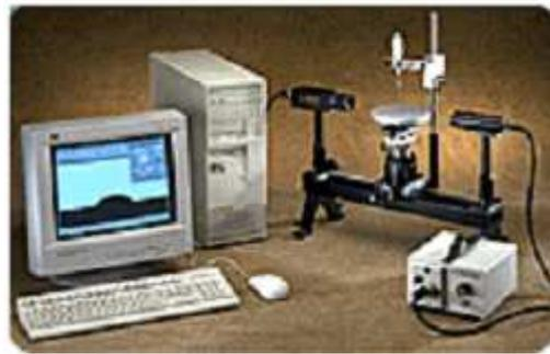
Figura 3.4: Goniômetro para medida do ângulo de contato.
