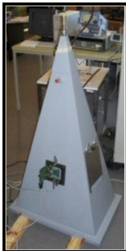
Figura 7.6 – GTEM-Cell utilizada para PCBs de teste com 10x10cm (PICCOLI, 2006).
