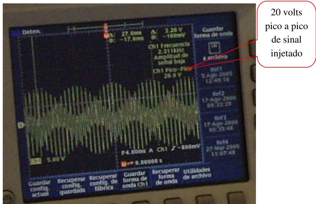
Figura 8.33 – Captura da tela do osciloscópio mostrando o sinal de ruído injetado na placa com uma tensão pico a pico de 20 volts.
