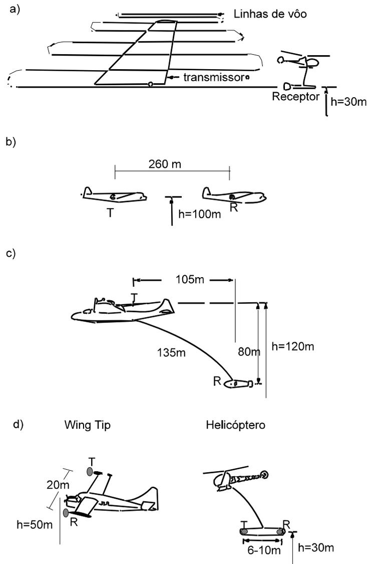
**Figura 1.12:** Geometria dos sensores transmissor (T) e receptor (R) para cinco tipos básicos de sistemas aeroeletromagnéticos. a) transmissor fixo; b) dois aviões um com receptor e outro com transmissor; c) transmissor no avião e receptor no charuto (towed bird); d) transmissor e receptor nas extremidades das asas do avião (wing tip); e) transmissor e receptor no charuto carregado por helicóptero (Modificado de Palacky e West, 1991).
