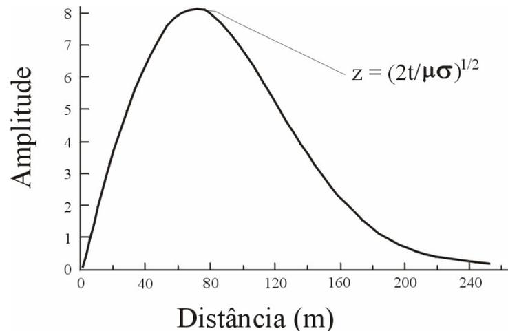
**Figura 2.2:** Campo magnético ou elétrico (para  $t = 0,03\text{ms}$ ) em função da distância, para um tempo fixo  $t=0,03\text{ms}$  (modificado de Nabighian & Macnae, 1987a).
