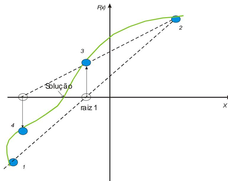
**Figura 1A:** Método da secante. As linhas pontilhadas são obtidas através de dois pontos (valores) mais recentes. Os pontos são numerados em sua ordem de utilização.
