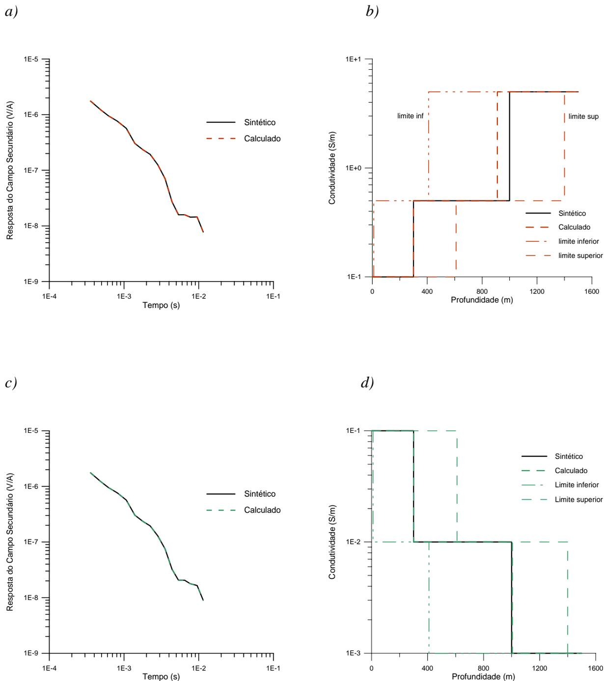
**Figura 7.2:** (a) (—) resposta do modelador direto para o Modelo 1 (condutividade crescente), (---) resposta do modelo inverso; b) (—) Modelo 1 de condutividade crescente; (---) Modelo inverso; (---) limite inferior; (---) limite superior; (c) (—) resposta do modelador direto para o Modelo 2 (condutividade decrescente), (---) resposta do modelo inverso; d) (—) Modelo 2 de condutividade decrescente; (---) Modelo inverso.
