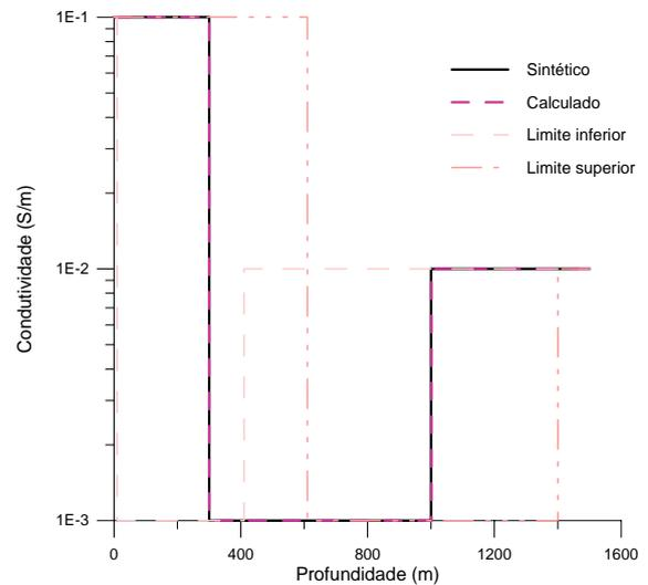
**Figura 7.3:** (a) (—) resposta do modelador direto para o Modelo 3 (condutividade mista), (---) resposta do modelo inverso; b) (—) Modelo 3 de condutividade crescente; (---) Modelo inverso; c) (—) resposta do modelador direto para o Modelo 4 (condutividade mista), (---) resposta do modelo inverso; d) (—) Modelo 4 de condutividade mista; (---) Modelo inverso.
