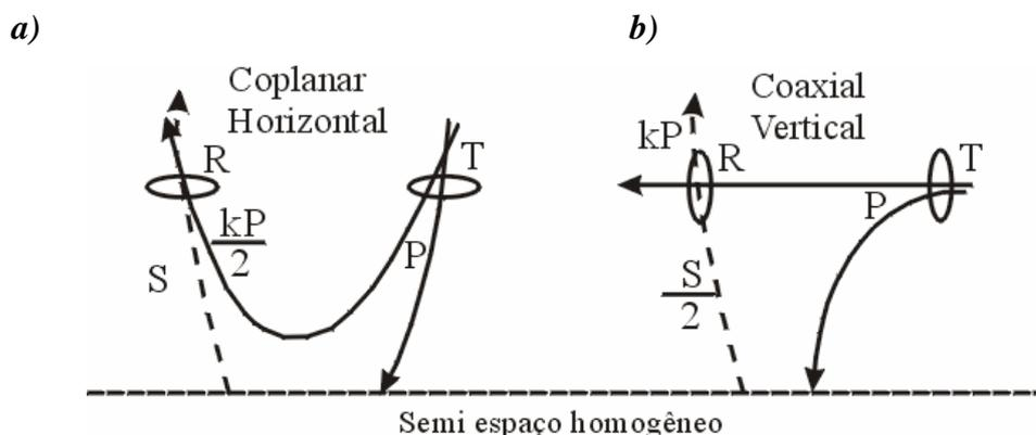
**Figura 1.2:** a) Bobina coplanar horizontal (eixos verticais); b) Bobina coaxial vertical (eixo paralelo à linha de voo). S: Campo secundário; P: campo primário; R: receptor; T: transmissor; k: constante (modificado de Geoterrex-dighem, 1999).
