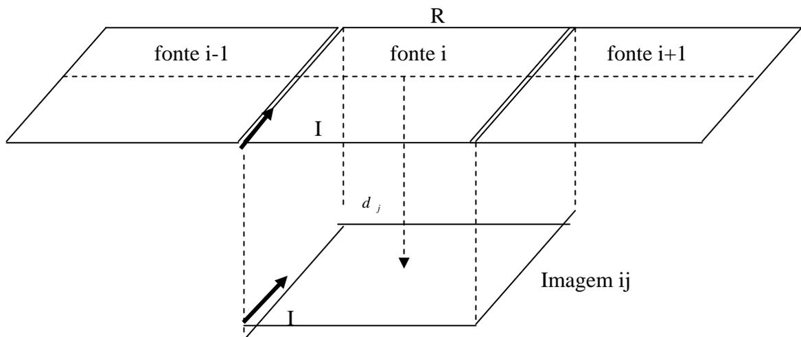
**Figura 8.2:** Sondagem e imagem da  $i$ -ésima fonte no  $j$ -ésimo tempo para uma bobina transmissora quadrada.  $d_j$  é a profundidade da imagem,  $R$  e  $I$  é a dimensão e a corrente da fonte (Adaptado de Eaton & Hohmann, 1989).
