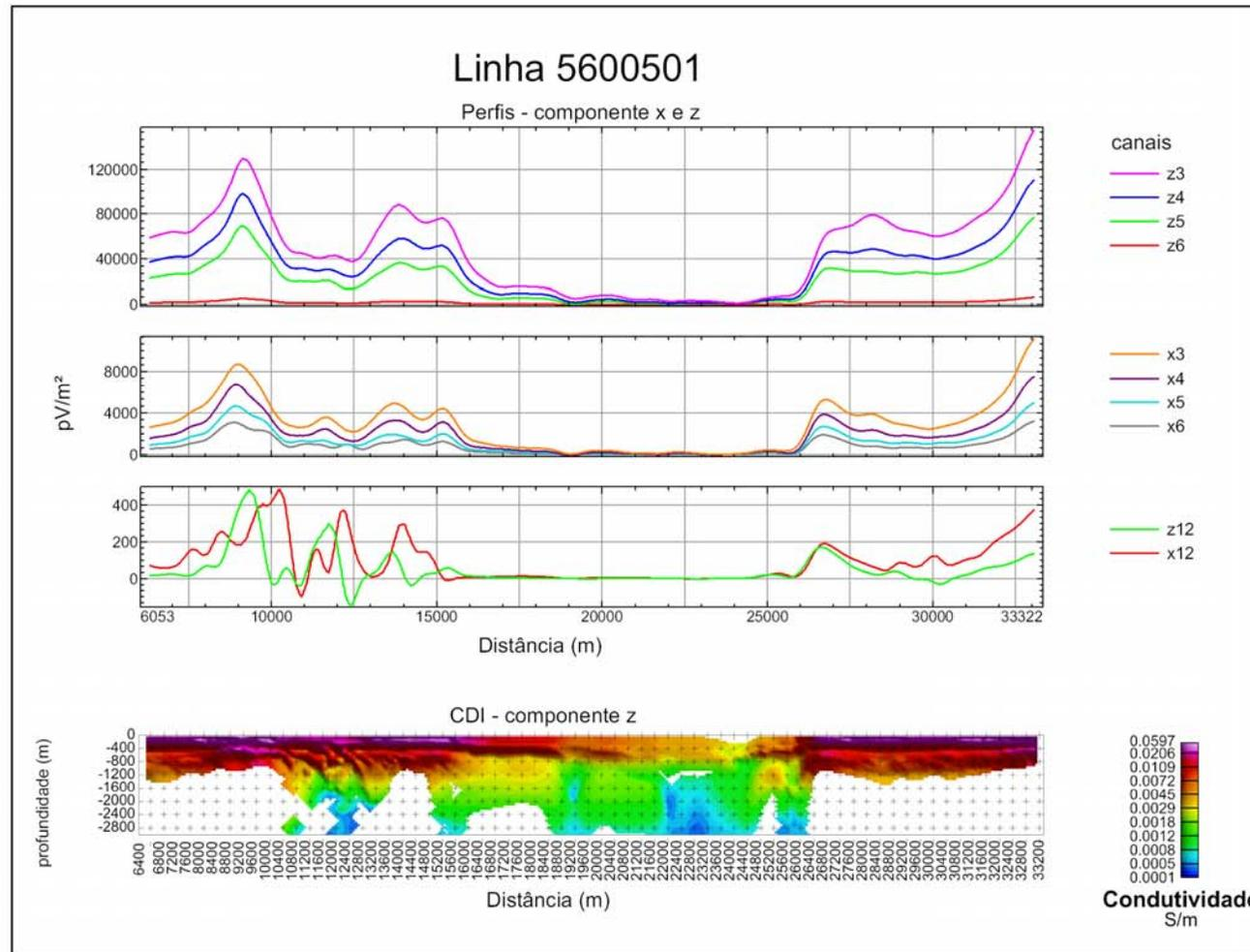
**Figura 9.23:** CDI (componente z) e perfis (componentes x e z) da linha 5600501
