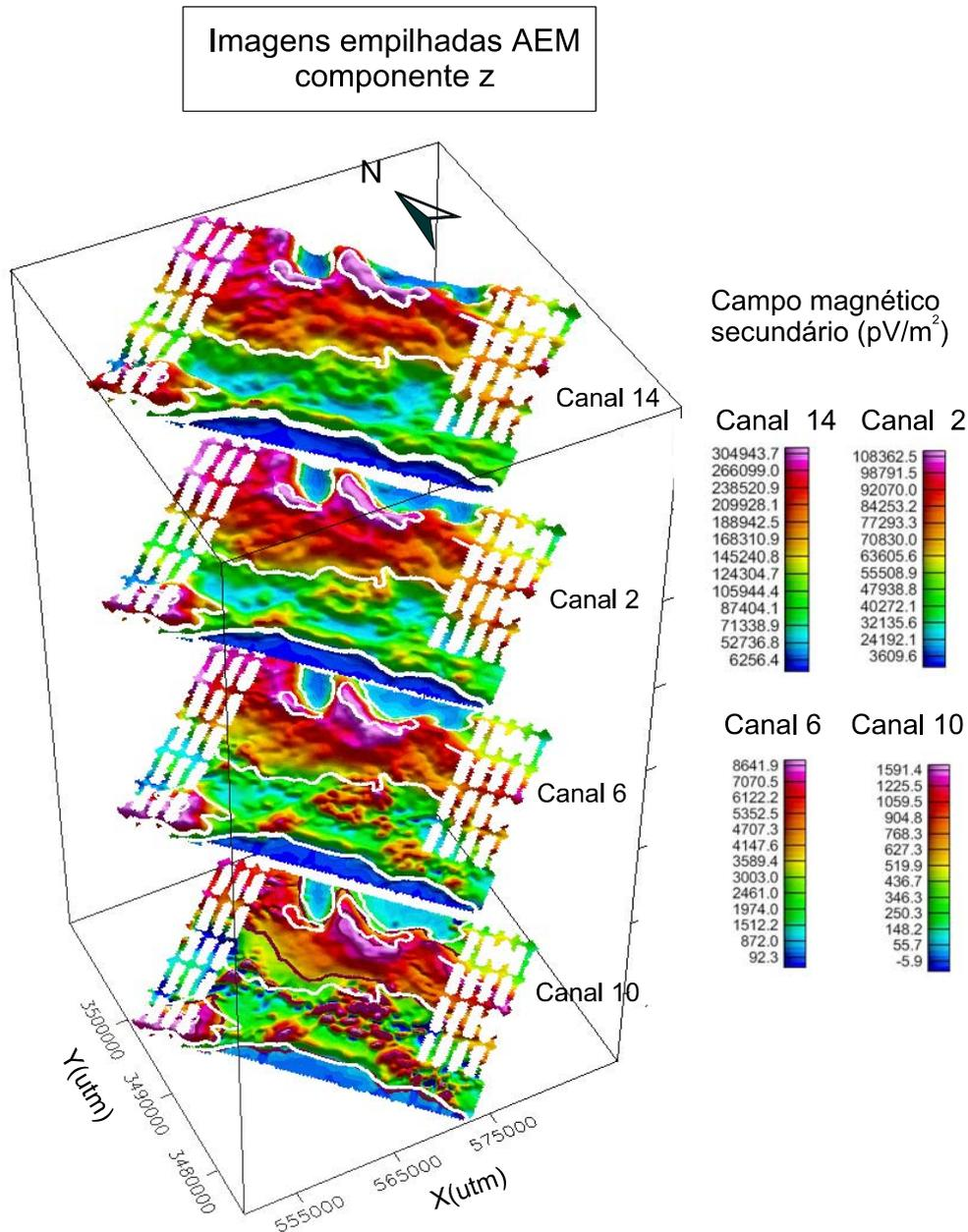
**Figura 9.8:** Mapa dos canais 14, 2, 6 e 10 do campo secundário (componente z) obtido no levantamento AEM ( $pV/m^2$ ). O contorno em branco representa a mudança do comportamento do campo AEM, baseado no canal 14 componente z; e o contorno em vermelho representa a mudança do comportamento do campo AEM, baseado no canal 10 componente z.
