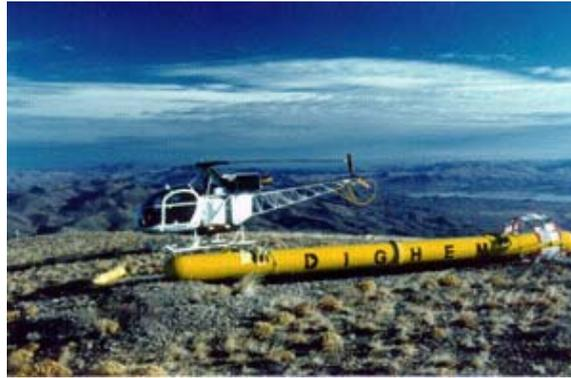
**Figura 1.5:** Sistema AEM com charuto (geoterrex-dighem 1999).
