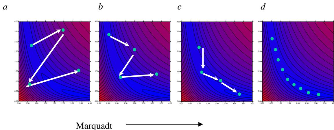
**Figura 4.2** Parâmetro de Marquadt – estabilizando o passo (modificado de Silva, 2002).
