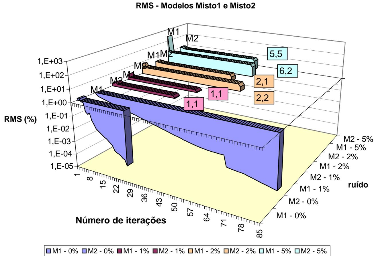
*Figura 7.11: Gráfico da variação do rms com o número de iterações; para os modelos 3 e 4, respectivamente, camada central condutiva (M1) e camada central resistiva (M2). Os valores em destaque representam o rms em percentagem para os modelos contaminados com 1%, 2% e 5% de ruído gaussiano.*
