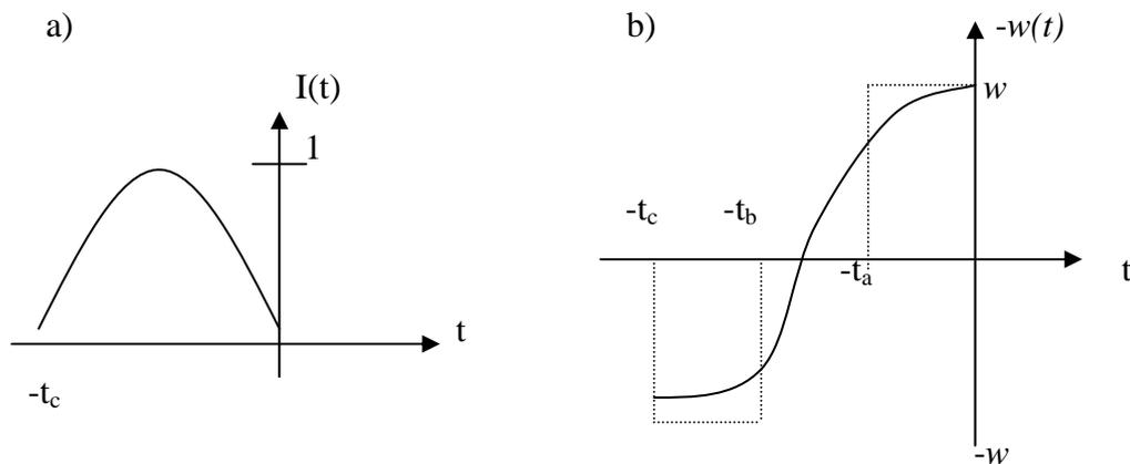
**Figura 8.3:** a) Forma de onda da corrente empregada; b) forma de onda da derivada da corrente. Mostra um pulso típico do sistema AEM operando com frequência angular  $w$ . As linhas pontilhadas indicam o comprimento da função caixa onde a área da curva  $w(t)$  é mantida. Para o critério de área igual adotado, tem-se:  $t_a = 1/w$  e  $t_b = t_c - 1/w$ .
