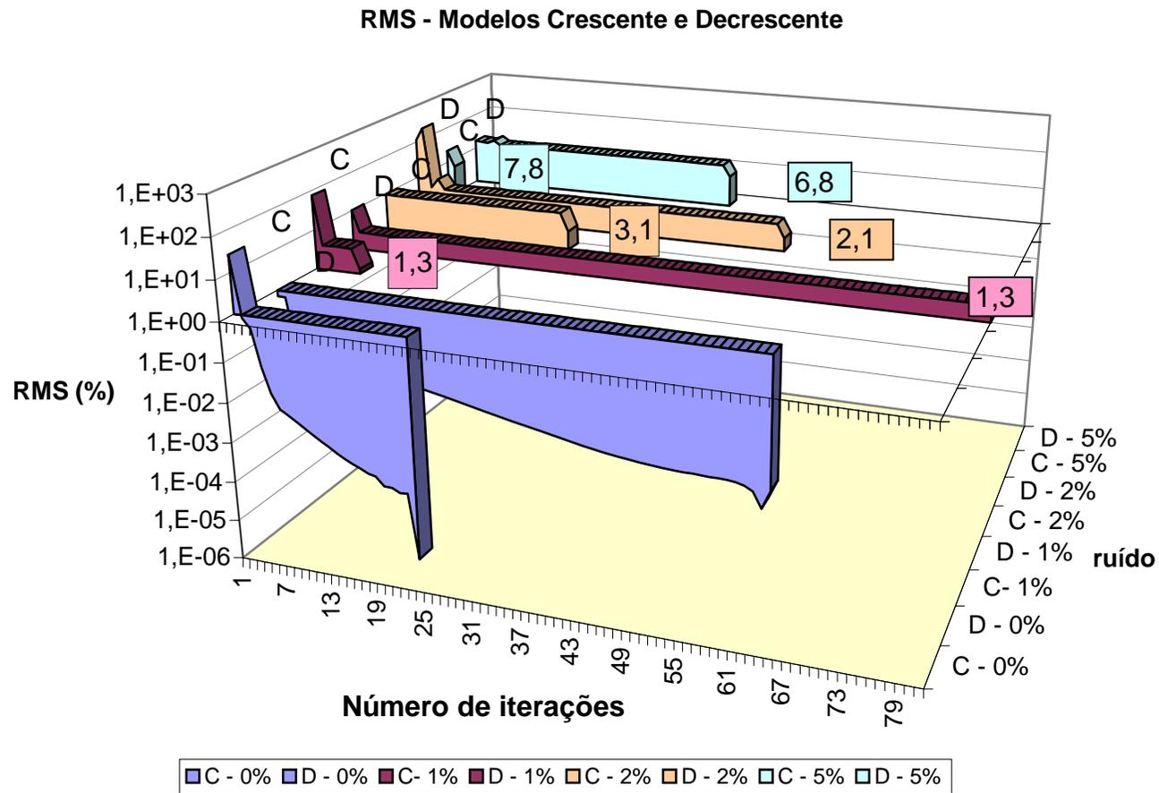
**Figura 7.10:** Gráfico da variação do rms com o número de iterações; para os modelos 1 e 2, respectivamente, condutividade crescente(C) e decrescente (D). Os valores em destaque representam o rms em percentagem para os modelos contaminados com 1%, 2% e 5% de ruído gaussiano.
