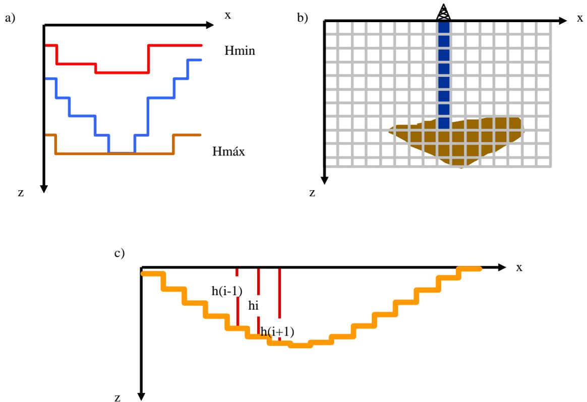
**Figura 3.4:** Vínculos utilizados nesta tese: a) desigualdade; b) Igualdade absoluta; c) Igualdade relativa (modificado de Silva, 2002).
