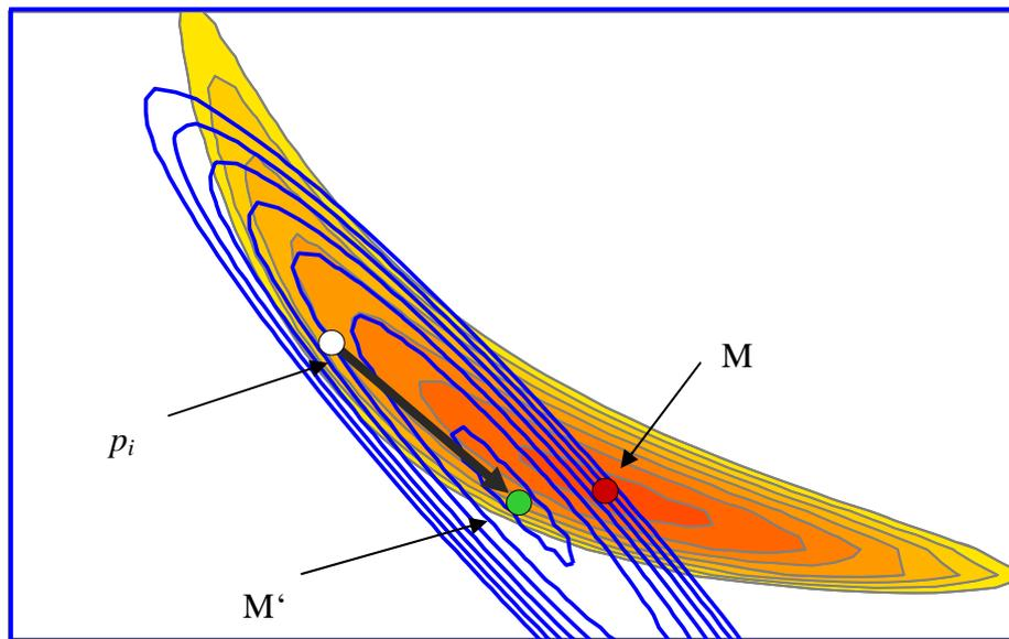
**Figura 4.1:** Aproximação pelo método de Newton. Em azul aproximação de segunda ordem de  $p_i$  de uma função arbitrária convexa com mínimo  $M$ . O mínimo  $M'$  de uma aproximação de segunda ordem é atingido após uma iteração do método de Newton (modificado de Silva et al., 2001).
