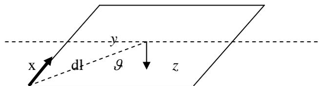
**Figura 8.1:** Configuração de uma bobina transmissora quadrada com dipolo elétrico ( $dl$ ) ao longo da bobina.
