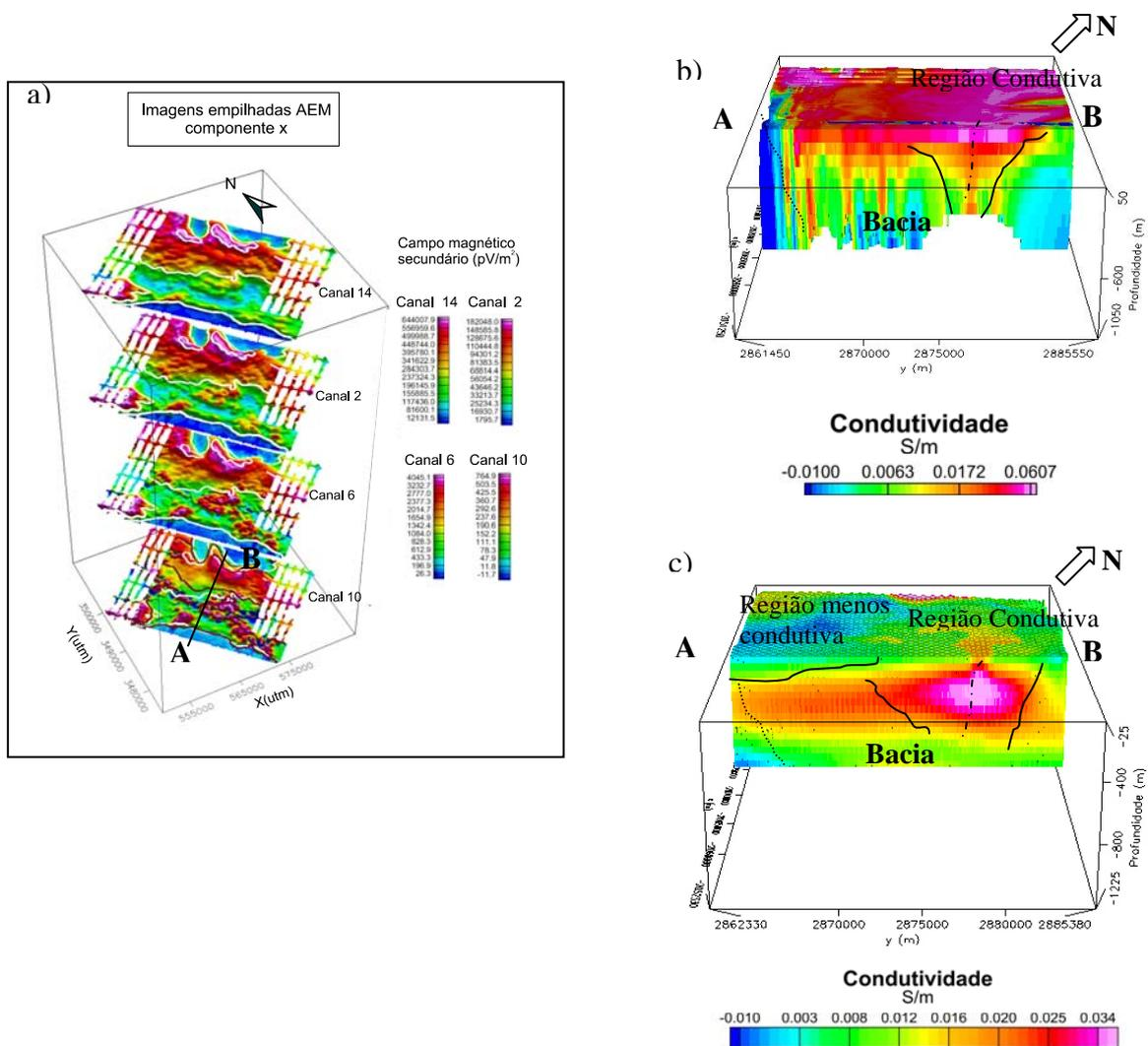
**Figura 9.31:** a) imagens da resposta AEM; b) voxel obtido utilizando as CDIs; c) voxel obtido pela inversão. Destaque para o perfil AB.
