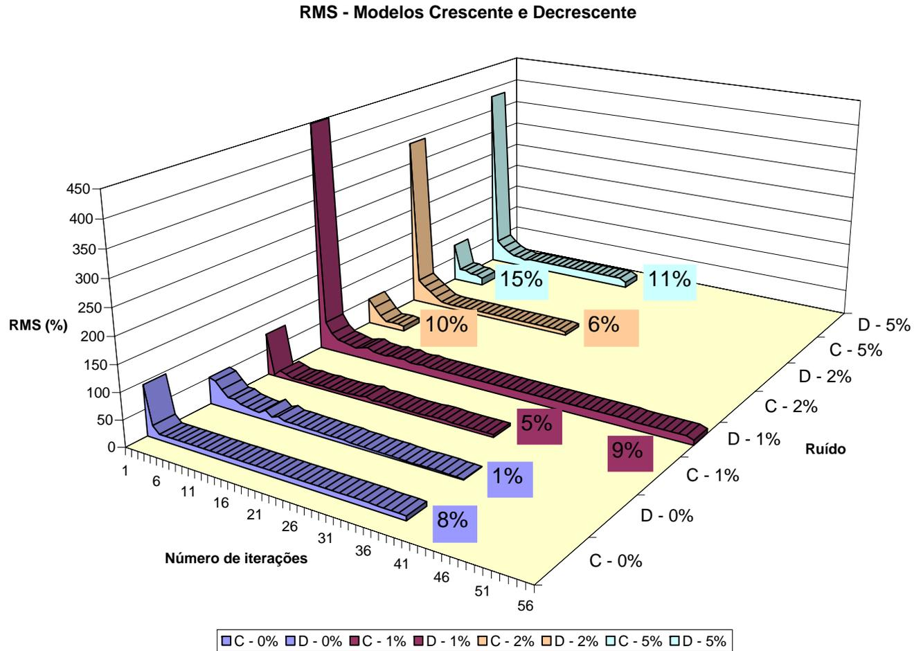
**Figura 7.21:** Inversão paramétrica: gráfico da variação do rms com o número de iterações; para os modelos 1 e 2, respectivamente, condutividade crescente(C) e decrescente (D). Os valores em destaque representam o rms em percentagem para os modelos contaminados com 1%, 2% e 5% de ruído gaussiano.
