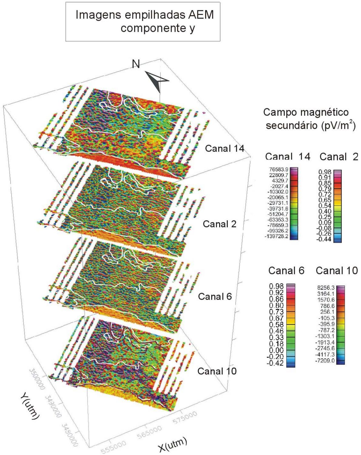
**Figura 9.10:** Mapa dos canais 14, 2, 6 e 10 do campo secundário (componente y) obtido no levantamento AEM ( $\text{pV/m}^2$ ). O contorno em branco representa a mudança do comportamento do campo AEM, baseado no canal 14 componente z; e o contorno em vermelho representa a mudança do comportamento do campo AEM, baseado no canal 10 componente z
