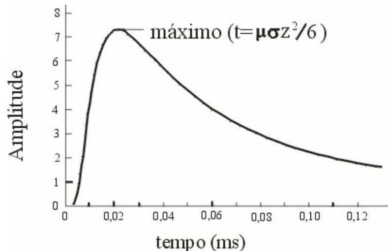
**Figura 2.1:** Campo magnético ou elétrico em função do tempo; para  $z=100\text{m}$  (modificado de Nabighian & Macnae, 1987a).
