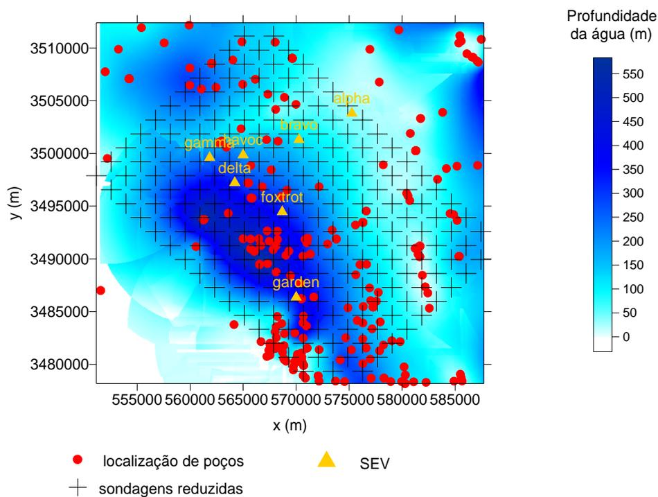
**Figura 9.28:** Mapa da profundidade da água com a localização dos poços, das sondagens reduzidas e das sondagens elétricas verticais (SEV) existentes na área.
