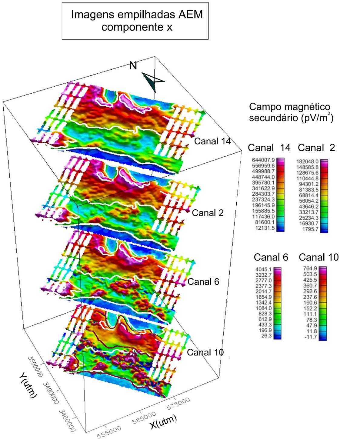
**Figura 9.9:** Mapa dos canais 14, 2, 6 e 10 do campo secundário (componente x) obtido no levantamento AEM ( $\text{pV/m}^2$ ). O contorno em branco representa a mudança do comportamento do campo AEM, baseado no canal 14 componente z; e o contorno em vermelho representa a mudança do comportamento do campo AEM, baseado no canal 10 componente z.
