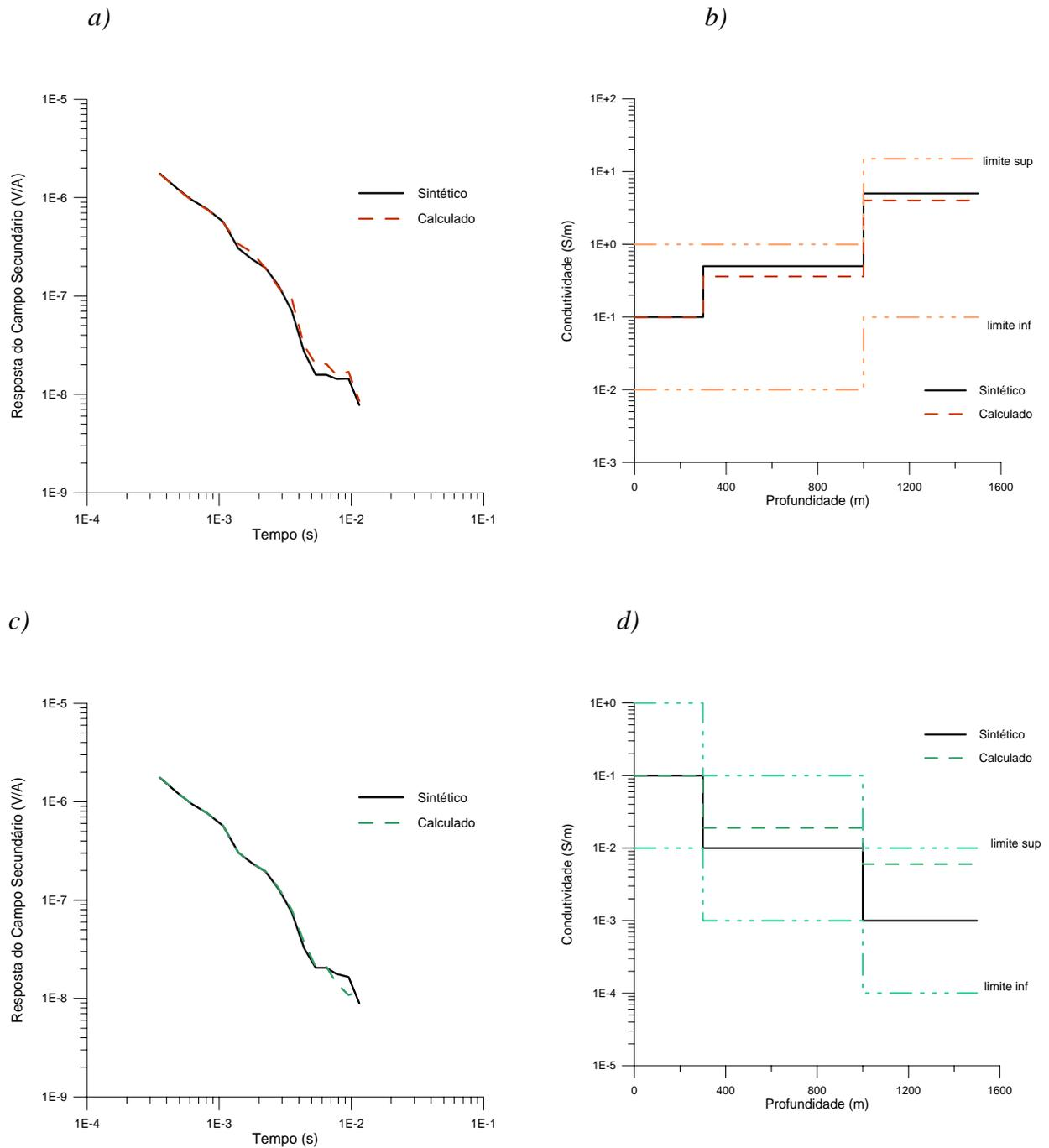
**Figura 7.13:** (a) (—) resposta do modelador direto para o Modelo 1 (condutividade crescente), (---) resposta do modelo inverso; b) (—) Modelo 1 de condutividade crescente; (---) Modelo inverso; (c) (—) resposta do modelador direto para o Modelo 2 (condutividade decrescente), (---) resposta do modelo inverso; d) (—) Modelo 2 de condutividade decrescente; (---) Modelo inverso.
