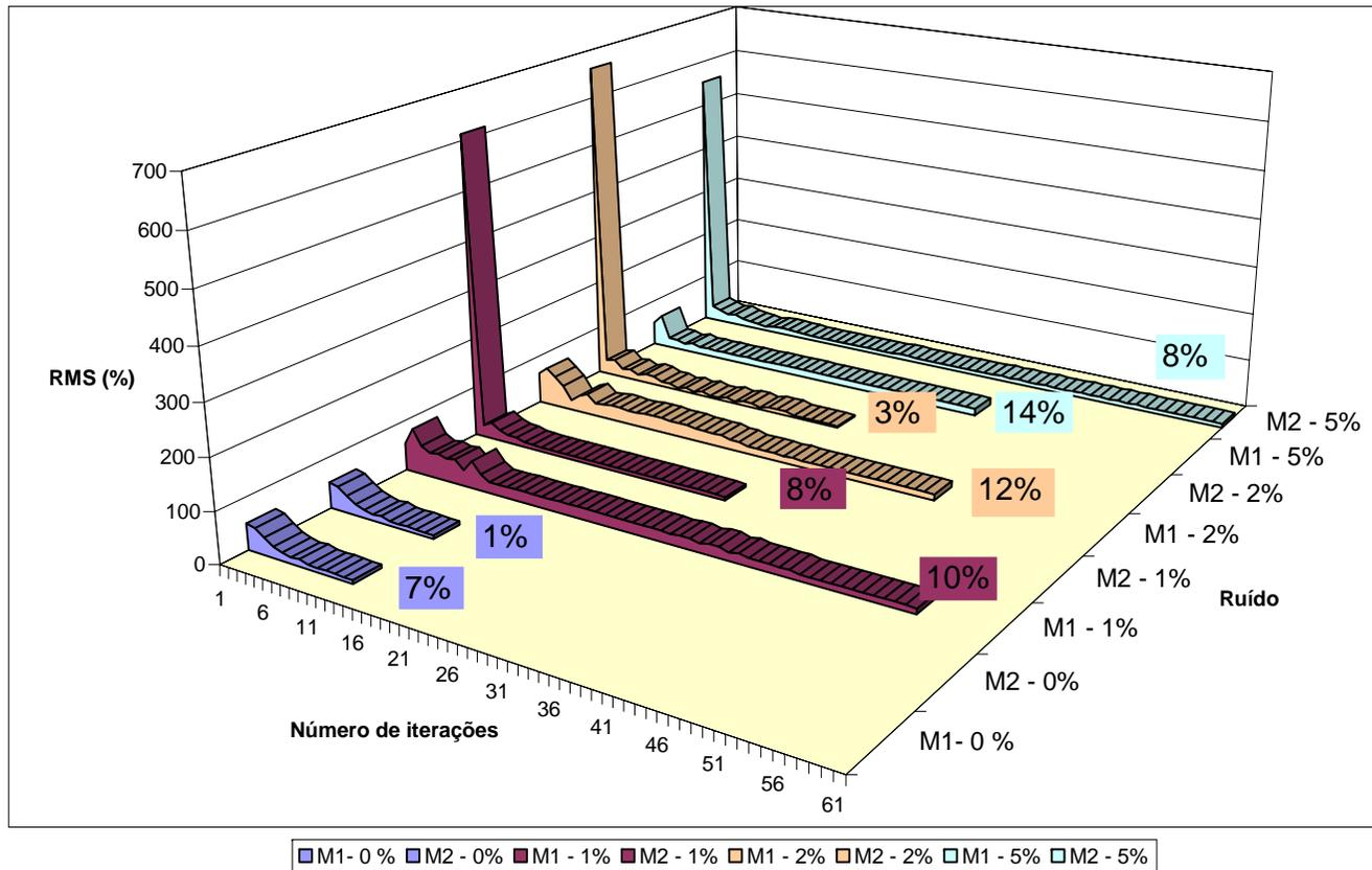
**Figura 7.22:** Inversão paramétrica: gráfico da variação do rms com o número de iterações; para os modelos 3 e 4, respectivamente, camada central condutiva (M1) e camada central resistiva (M2). Os valores em destaque representam o rms em percentagem para os modelos contaminados com 1%, 2% e 5% de ruído gaussiano.
