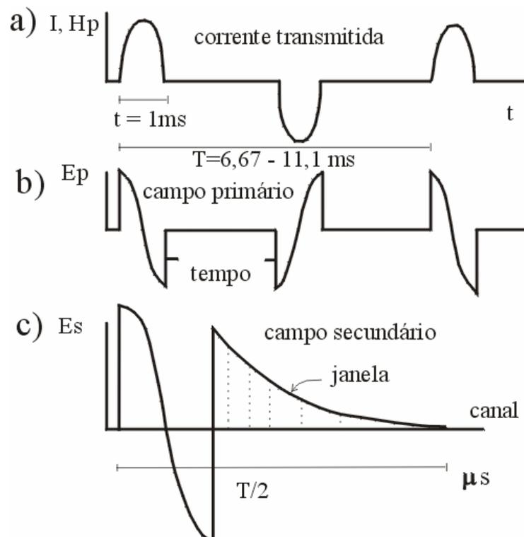
**Figura 1.13:** Funcionamento do INPUT **a)** Campo magnético e corrente transmissora; **b)** tensões desenvolvidas pela corrente (sinal primário); **c)** campos primário e secundário induzidos no receptor (transmissão desligada).  $I$ : corrente;  $H_p$ : campo magnético induzido;  $E_p$  e  $E_s$ : campo elétrico primário e secundário;  $T$ : tempo (Modificado de Palacky & West, 1991).
