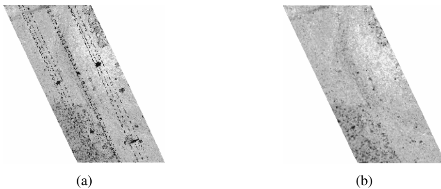
Figura 84 - Amostra F, (a) Imagem raster do primeiro retorno e, (b) imagem raster do último retorno.
