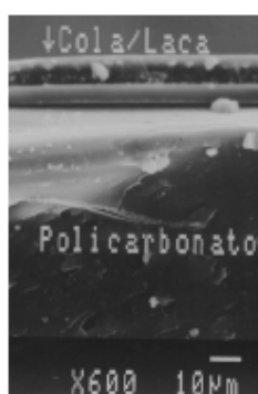
FIGURA 1 - Foto das camadas de um CD-ROM.
