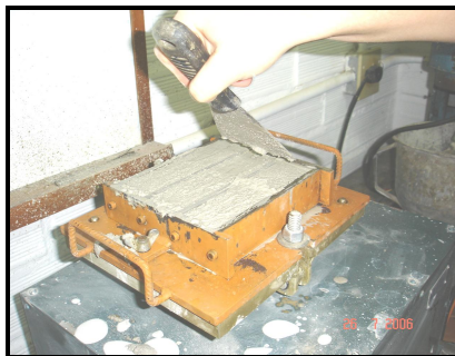
a) Molde prismáticos metálicos onde argamassa está sendo rasada
