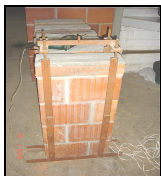
a) Pequena parede acondicionado em dispositivo para transporte da prensa
