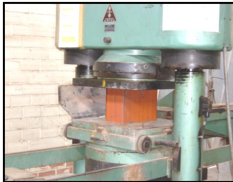
FIGURA 3.9 – Bloco com parede maciça submetido ao ensaio de resistência à Compressão.
