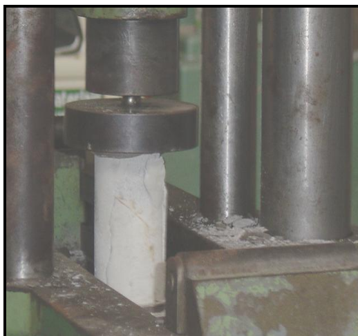
FIGURA 3.14 – Ruptura de corpo-de-prova.
