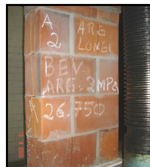
f) Pequena parede com argamassa longitudinal rompida
