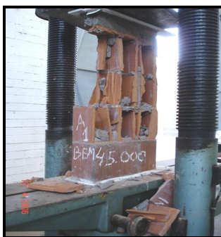
d) Pequena parede rompida a compressão pela prensa
