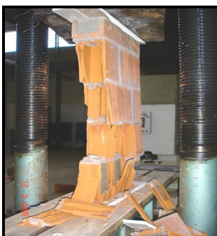
e) Pequena parede com argamassa plena rompida
