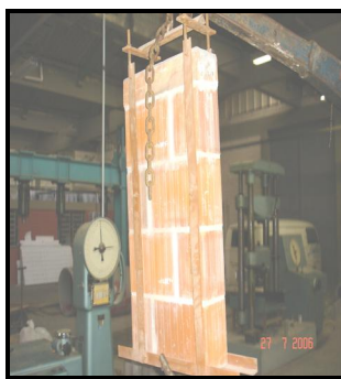
b) Pequena parede sendo transportada para a mesa da prensa
