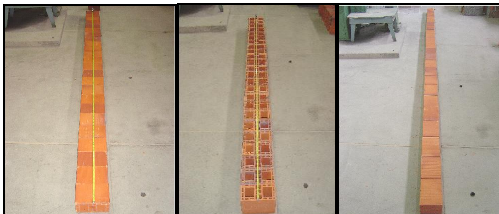
FIGURA 3.11 – Blocos sendo submetidos ao ensaio de dimensões nominais.
