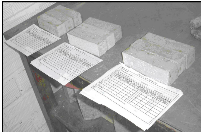
FIGURA 3.8 – Corpos-de-prova de argamassa industrializada 4 cm x 4 cm x 16 cm.
