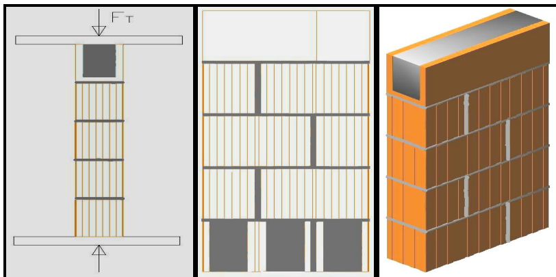
FIGURA 3.2 – Demonstrativo da pequena parede de blocos maciços, argamassa plena, com canaletas “u” e furos da 1º fiada grauteada.
