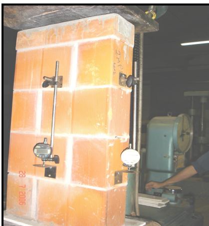
FIGURA 2.9 – Extensômetro mecânico comparador fixo com medidores digitais: utilizados nos corpos-de-prova desta dissertação.
