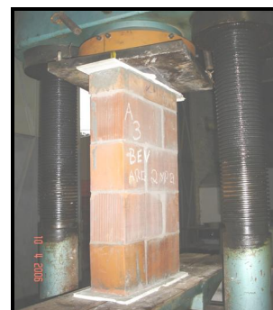
c) Pequena parede posicionada na mesa da prensa
