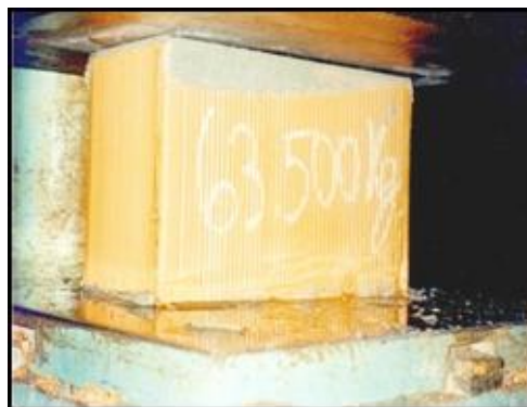
FIGURA 3.10 – Bloco parede vazada submetido ao ensaio de resistência à compressão.
