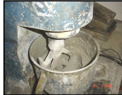
b) Misturador mecânico da argamassa
