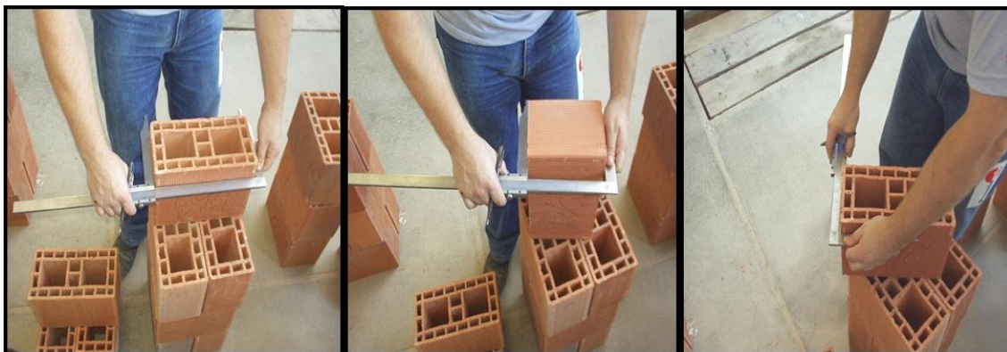
FIGURA 3.12 – Blocos sendo submetidos ao ensaio de inspeção por medida direta.
