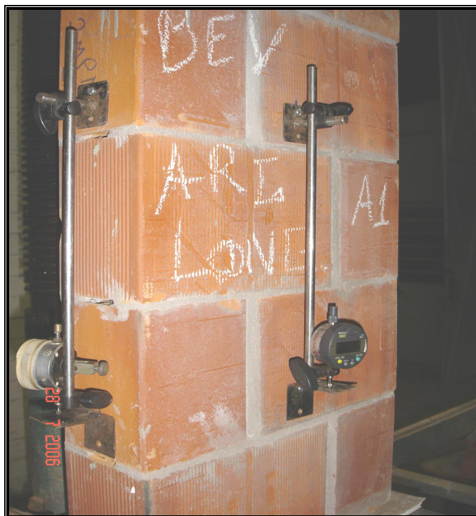
FIGURA 4.2 – Módulo de deformação – dispositivo de ensaio.
