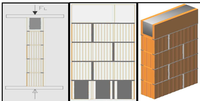
FIGURA 3.1 – Demonstrativo da pequena parede de blocos maciços, argamassa na longitudinal, com canaletas “u” e furos da 1º fiada grauteada.
