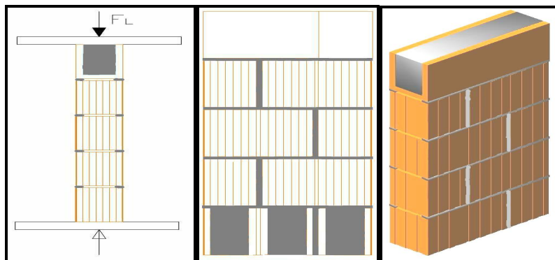
FIGURA 3.3 – Demonstrativo da pequena parede de blocos vazados com argamassa na longitudinal, com canaleta “u” e furos da 1º fiada grauteada.
