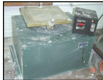
b) Nivelador de camadas máquina de adensamento da argamassa
