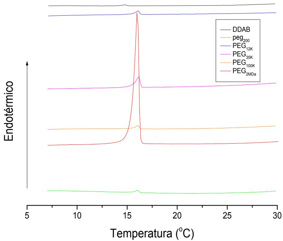
**Figura 30-** Termograma DSC, obtido por aquecimento das amostras, para os sistemas PEG/DDAB/água (0,1%/0,1%/99,8), para PEG<sub>200Da</sub>, PEG<sub>12K</sub>, PEG<sub>35K</sub>, PEG<sub>100K</sub> e PEG<sub>2MDa</sub>
