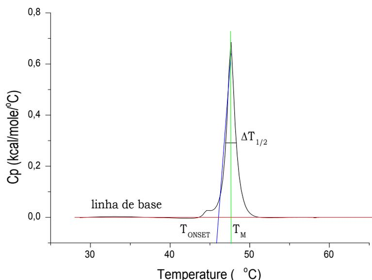
**Figura 10** – Esquema de uma curva e DSC, indicando os parâmetros obtidos para um sistema vesicular:  $T_m$ ,  $\Delta T_{1/2}$  e  $\Delta H$  (e  $T_{ONSET}$ )
