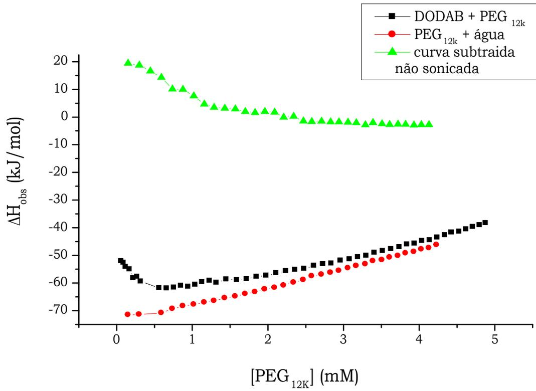
**Figura 24** – Variação da entalpia medida em função de PEG<sub>12K</sub> adicionado a solução de DODAB 1,0 mM (25°C, < T<sub>M</sub>).
