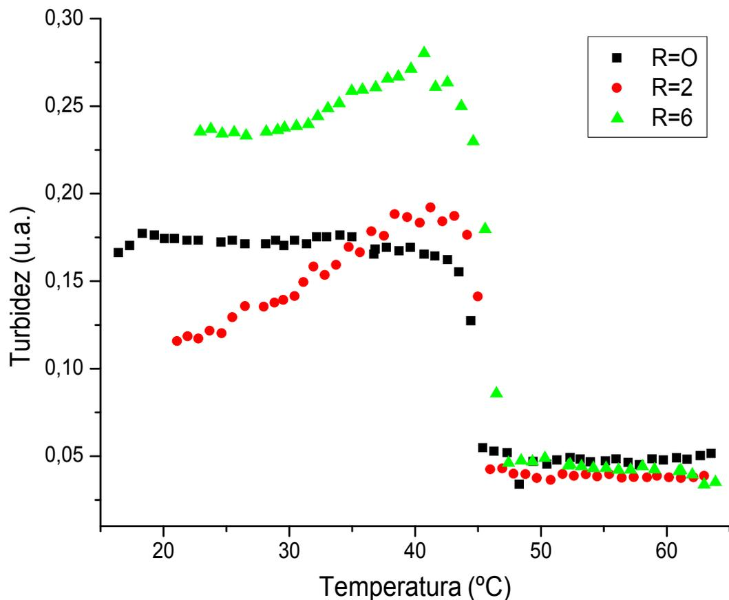
**Figura 17** – Turbidez ( $\lambda = 500 \text{ nm}$ ) de DODAB 1 mM, na ausência e presença de PEG<sub>12K</sub>, em função da temperatura, para as razões molares  $R = \text{PEG}_{12K}/\text{DODAB} = 0, 2 \text{ e } 6$ . Amostra não sonicada.
