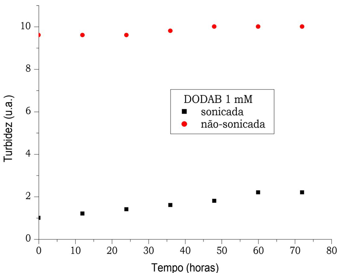
**Figura 11** - Efeito do tempo na turbidez ( $\lambda = 550$  nm) de vesículas de DODAB 1,0 mM (0,06 % p/p) sonicadas e não sonicadas em água a 25 °C (curva normalizada).
