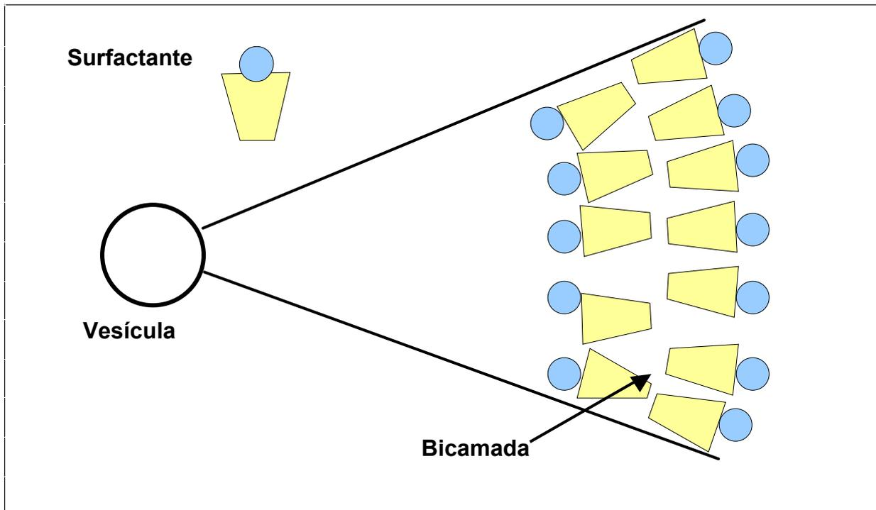
**Figura 2** – Esquema da estrutura de um típico surfactante e uma vesícula em corte formada desse surfactante em solução aquosa. As cores azul e amarela representam as porções hidrofílica e hidrofóbica do surfactante. Nota-se que a geometria cônica truncada do surfactante é a mais apropriada para formar vesículas.
