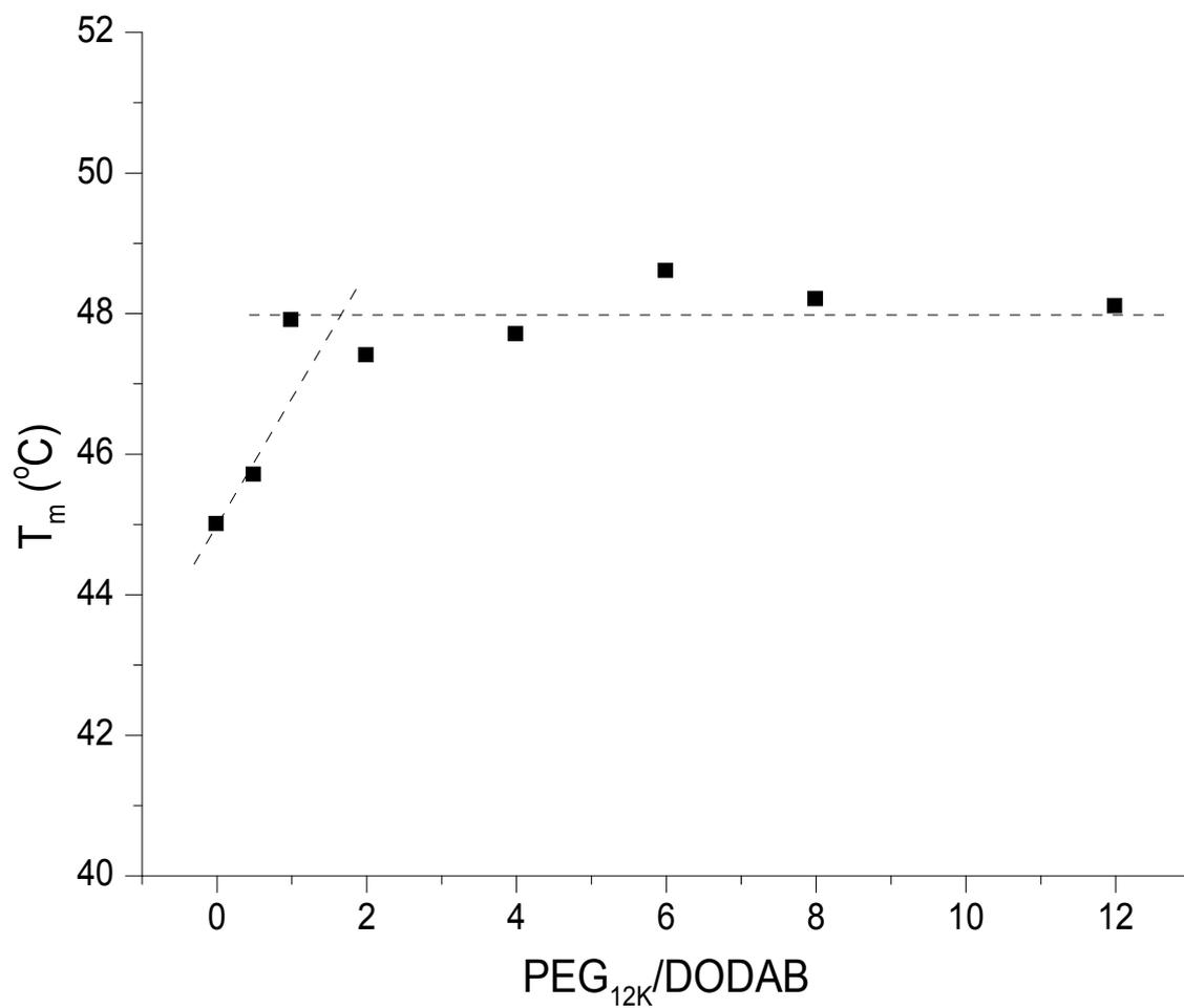
**Figura 22** – Temperatura de transição ( $T_m$ ), obtida por DSC, em função da razão de concentração molar  $R = PEG_{12K}/DODAB$ , para amostra não sonicada.
