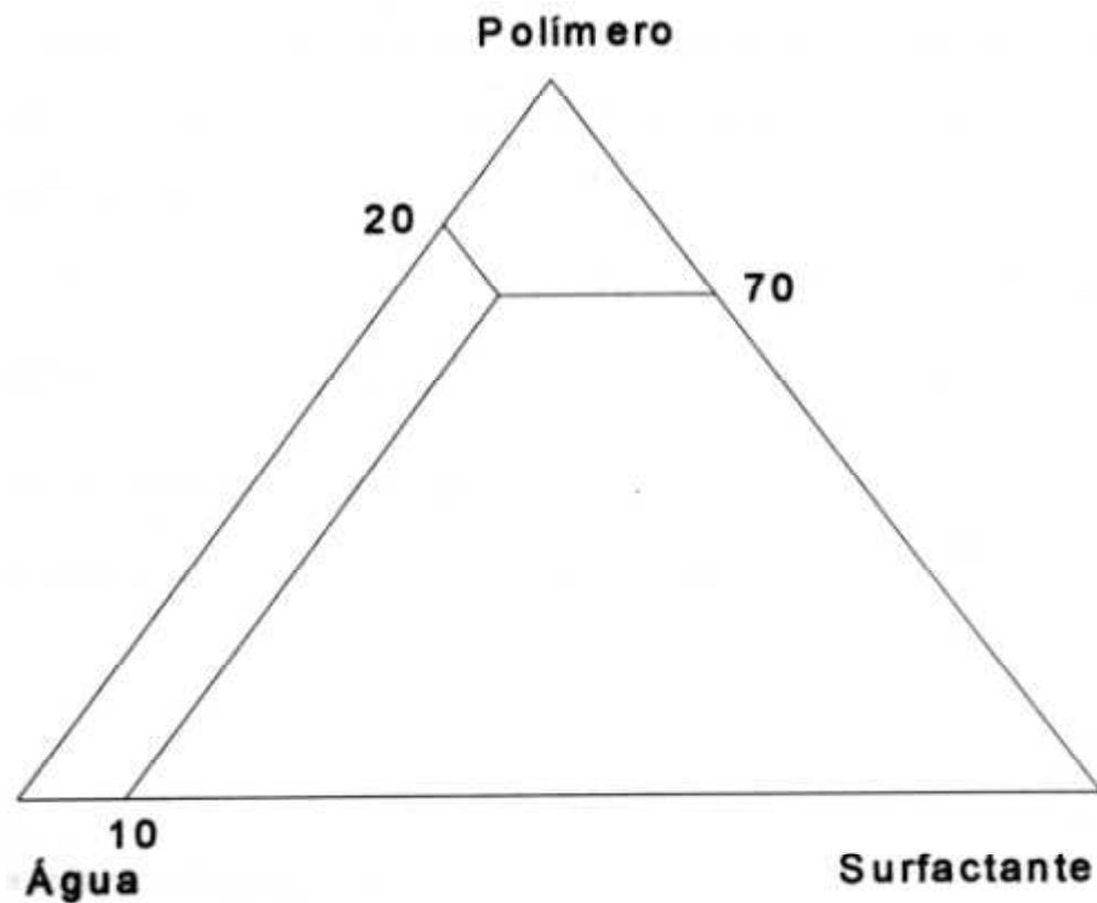
**Figura 9** – Triângulo de Gibbs para a construção de diagrama ternário de fases esquemático de três componentes: polímero, surfactante e água à temperatura fixa. As composições dos diferentes componentes no ponto P são dadas pela distância da base oposta. A amostra representada pelo ponto P é composta de 70% de polímero, 20% de água e 10% de surfactante.
