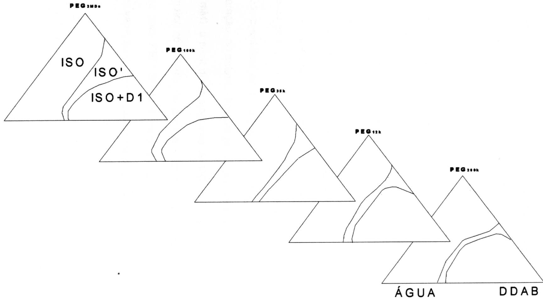
**Figura 28** - Diagramas ternários de fases do sistema PEG/DDAB/água, para o PEG com massa molecular variando de 200 Da a 2 MDa, 25°C.
