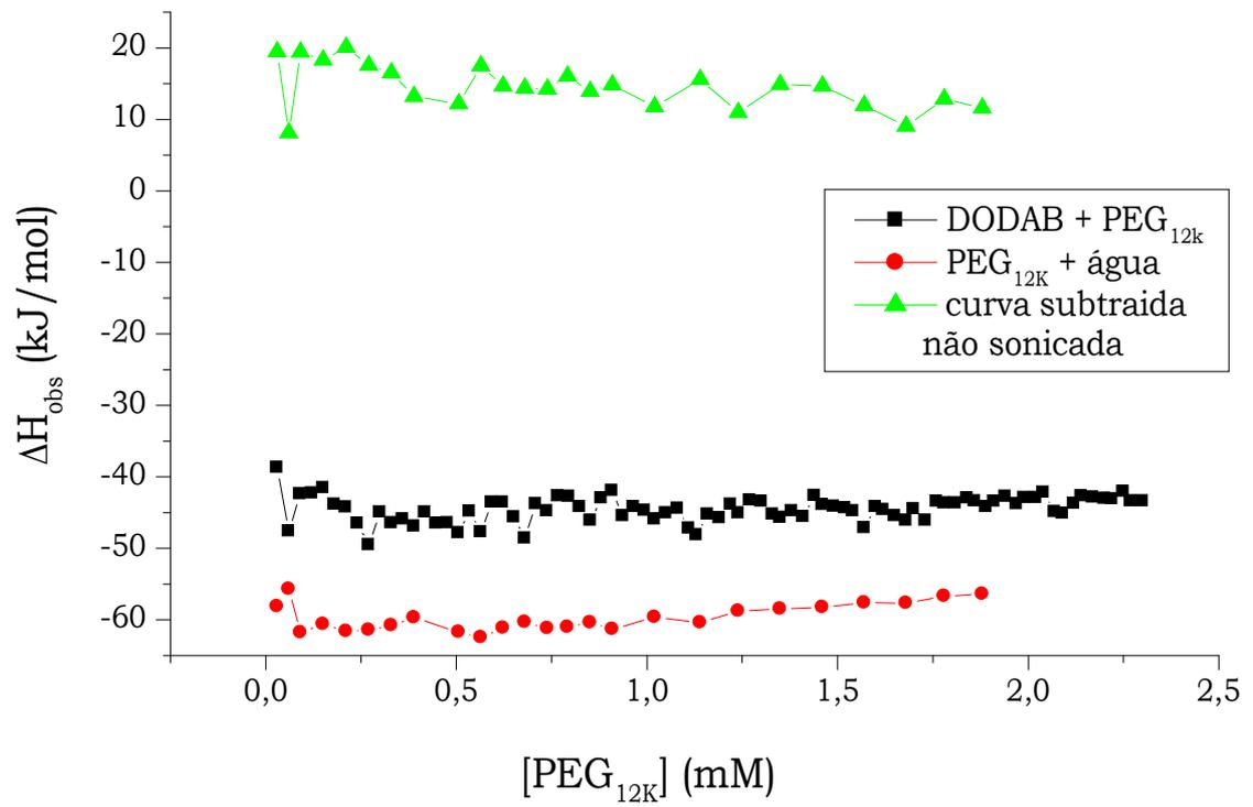
**Figura 25** – Variação da entalpia medida em função de  $\text{PEG}_{12\text{K}}$  adicionado a solução de DODAB 1,0 mM ( $50^\circ\text{C}$ ,  $>T_M$ ).
