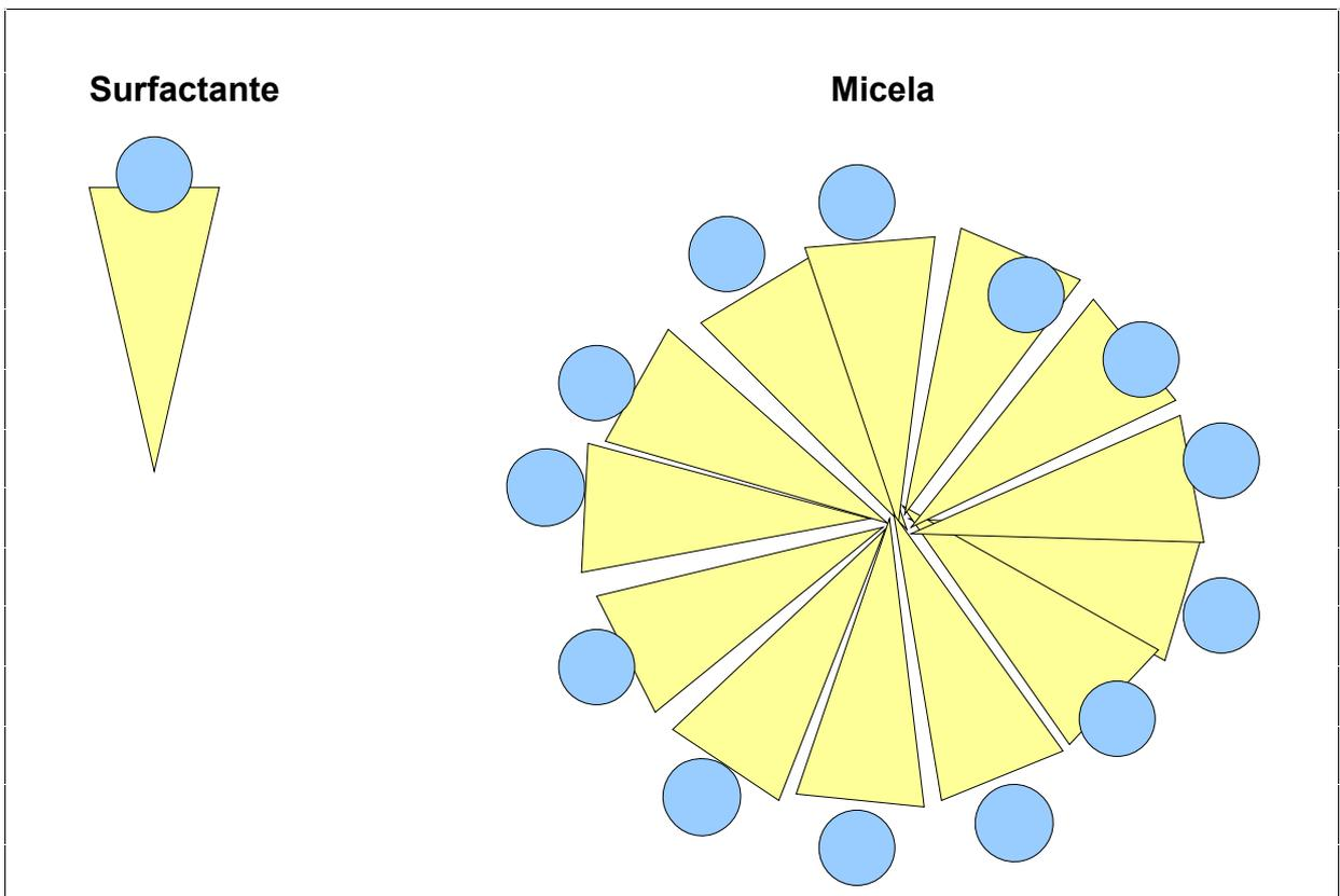
**Figura 1** – Esquema da estrutura de um típico surfactante e uma micela, esférica ou cilíndrica, formada desse surfactante em solução aquosa, visto em corte. As cores azul e amarela representam as porções hidrofílica e hidrofóbica do surfactante. Nota-se que a geometria cônica do surfactante é a mais apropriada para formar micelas esféricas ou cilíndricas.
