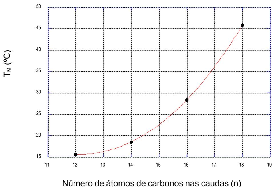
**Figura 5** – Temperatura de transição gel-líquido cristalino ( $T_m$ ), obtida por calorimetria diferencial de varredura, em função do número de átomos de carbono ( $n$ ) nas caudas de surfactantes dialquilados derivados da amônia quaternária (FEITOSA, JANSSON & LINDMAN, 2005).
