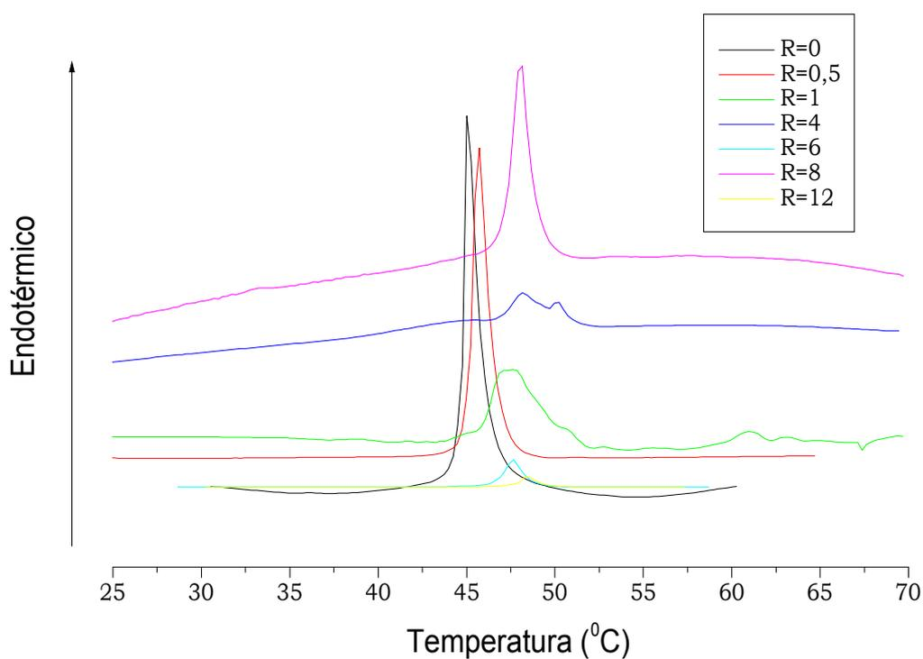
**Figura 21** – Termograma de DSC de DODAB1mM em dispersão aquosa de vesícula não-sonicada na ausência e presença de PEG<sub>12k</sub> (R= 0, 0,5; 1,0; 4,0; 6,0 e 12,0).
