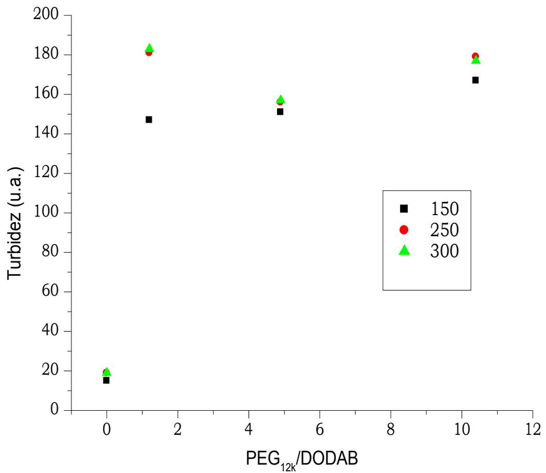
**Figura 15** - Efeito da concentração de PEG<sub>12K</sub> na turbidez ( $\lambda = 550$  nm) de vesículas de DODAB 1,0 mM (0,06% p/p) sonicadas em água, a 25 °C, após os tempos de 150, 250 e 300 horas, conforme legenda.
