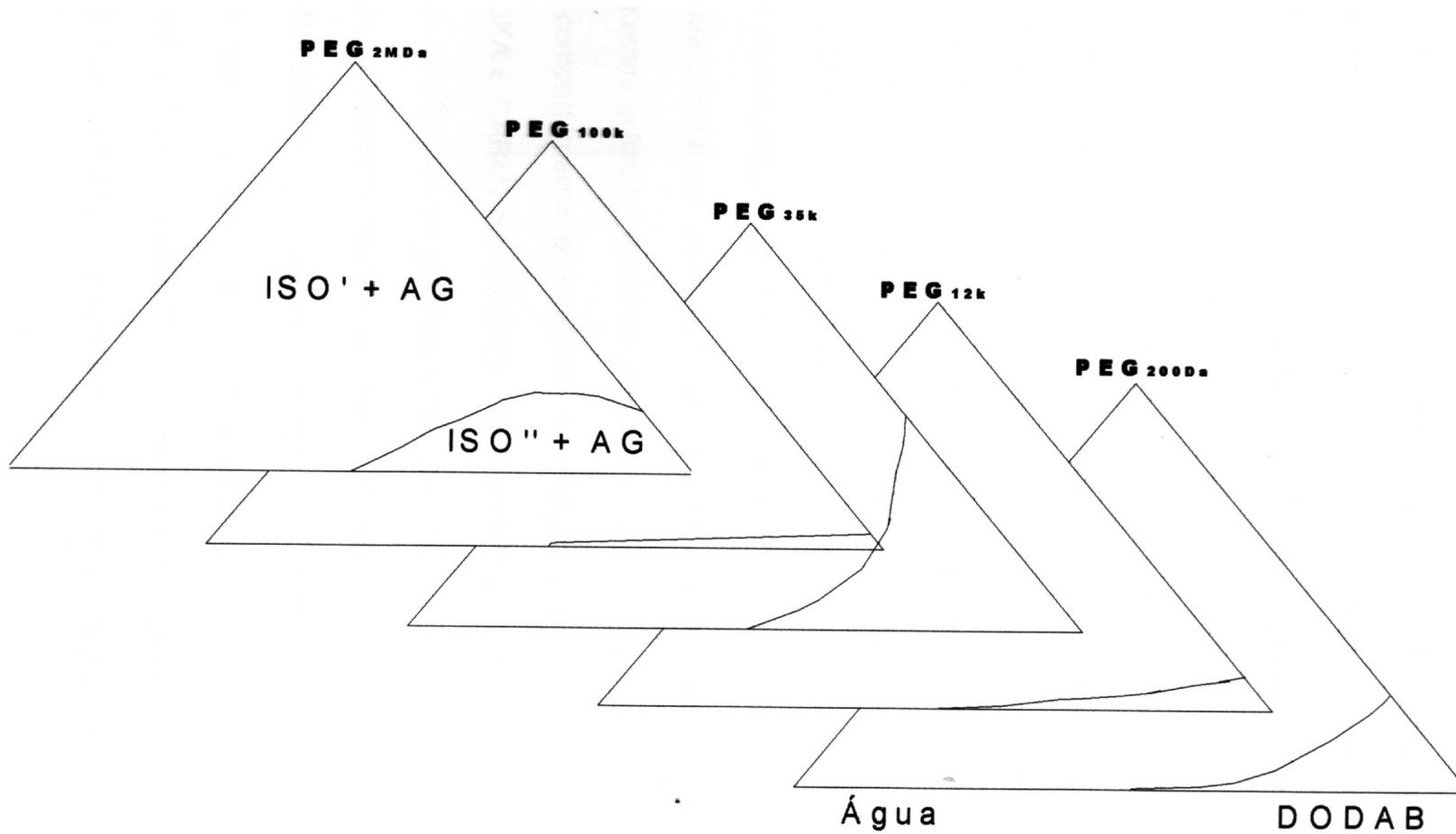
**Figura 31** - Diagramas ternários de fases do sistema PEG/DODAB/água, para PEG com massa molecular variando de 200 Da a 2 MDa, 25°C.
