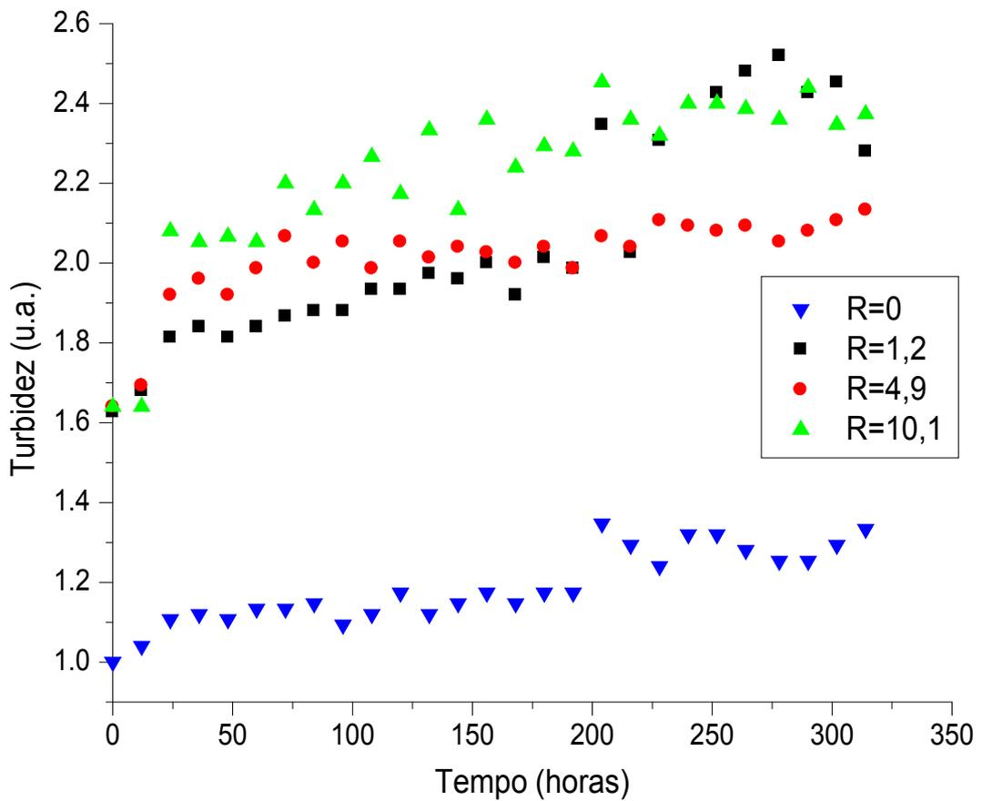
**Figura 13** - Efeito do tempo na turbidez ( $\lambda = 550 \text{ nm}$ ) de vesículas de DODAB 1,0 mM (0,06% p/p) sonicadas em água, e concentrações crescentes de PEG<sub>12K</sub>, para  $R = \text{PEG/DODAB} = 0; 1; 2; 4,9$  e  $10,1$  a  $25 \text{ }^\circ\text{C}$  (curvas normalizadas).
