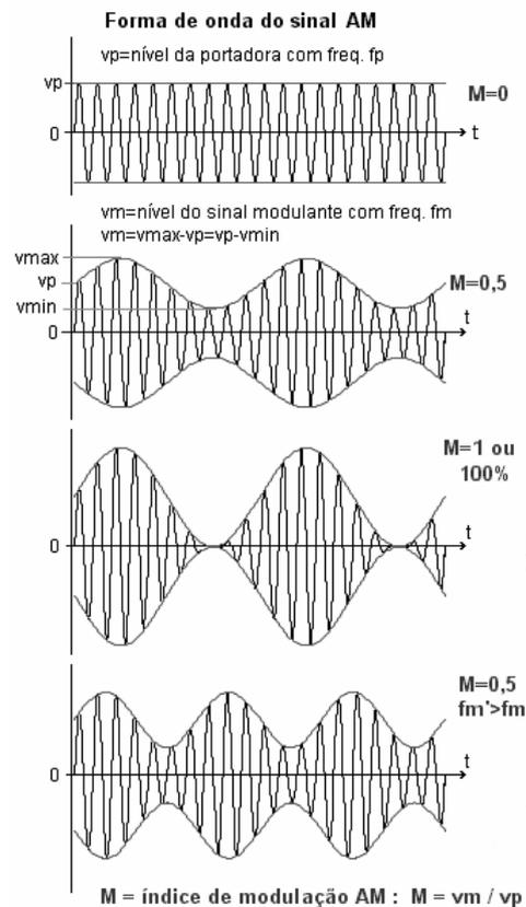
Figura 21 – Exemplo de Sinal AM com modulante senoidal.
