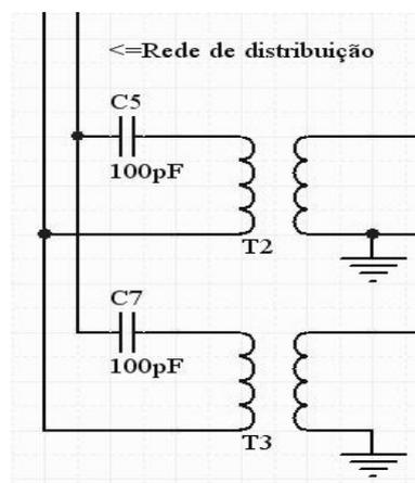
Figura 26 – Circuito de acoplamento com a rede.
