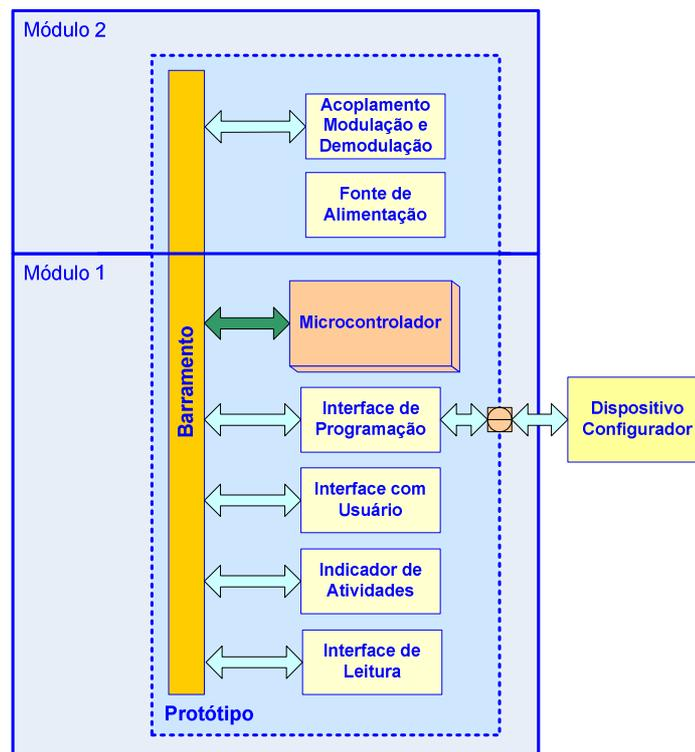
Figura 29 – Divisão dos Módulos do protótipo.
