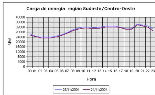
Figura 1 – Curva de carga típica diária.
