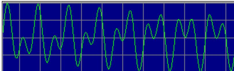
Figura 14 – Forma de onda do sinal DTMF da tecla D [17].
