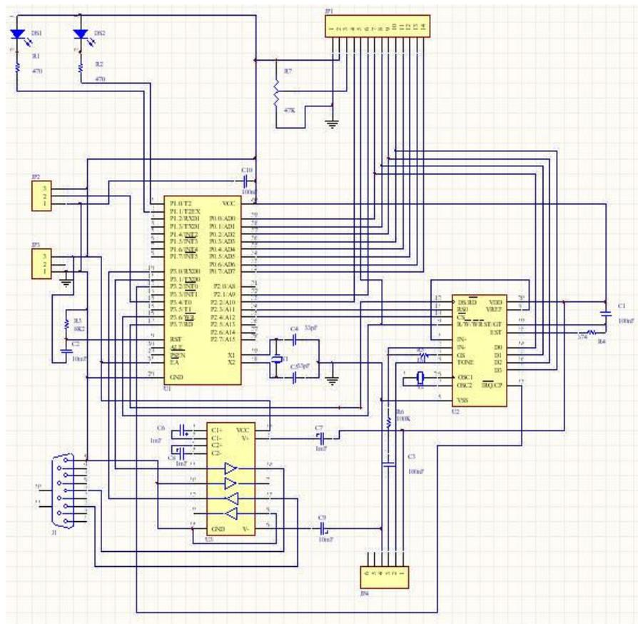
Figura 30 – Esquema elétrico do Módulo 1 - protótipo.
