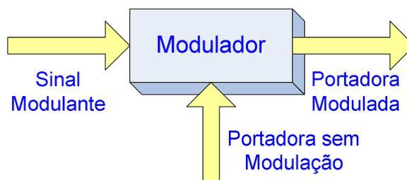
Figura 20 – Esquema de um modulador de sinal.
