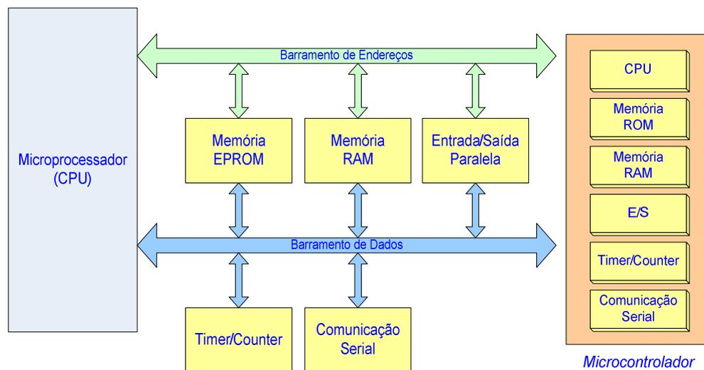
Figura 9 – Comparação entre Microprocessador e Microcontrolador.
