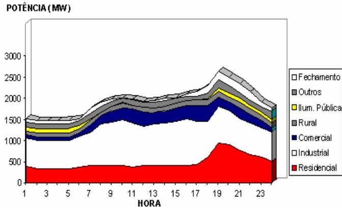
Figura 3 – Desagregação da curva de carga.
