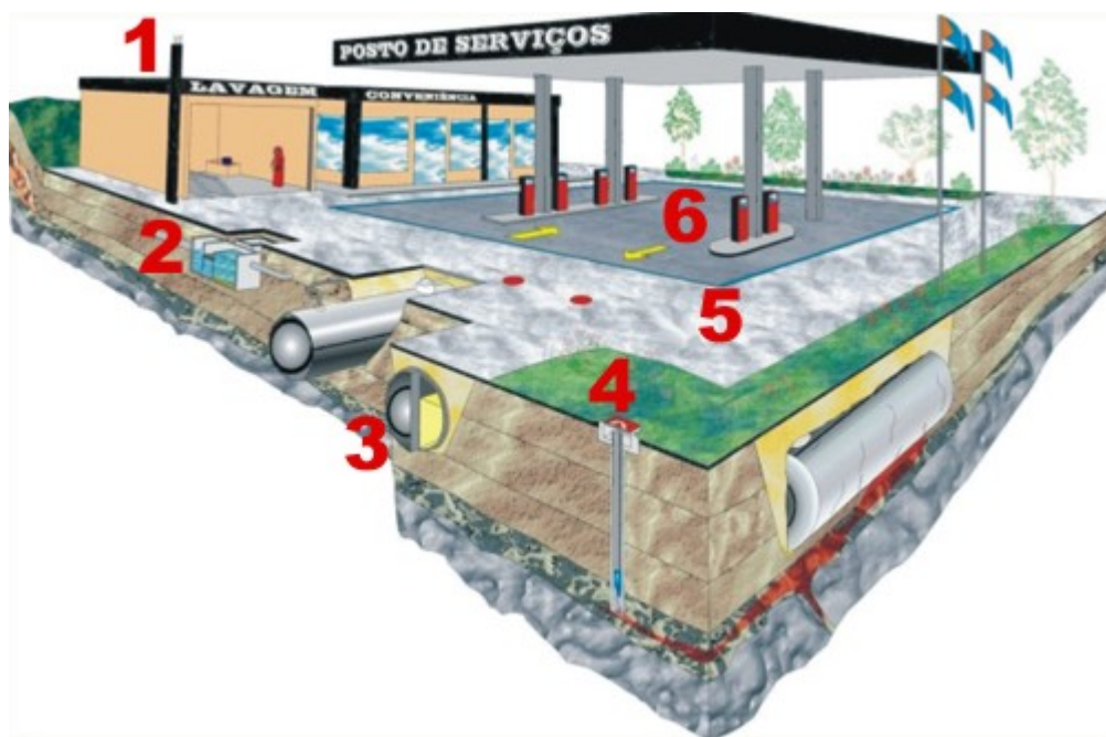
Figura 05. Principais equipamentos exigidos num posto de combustível (Fonte: ROCHE, 2003)
