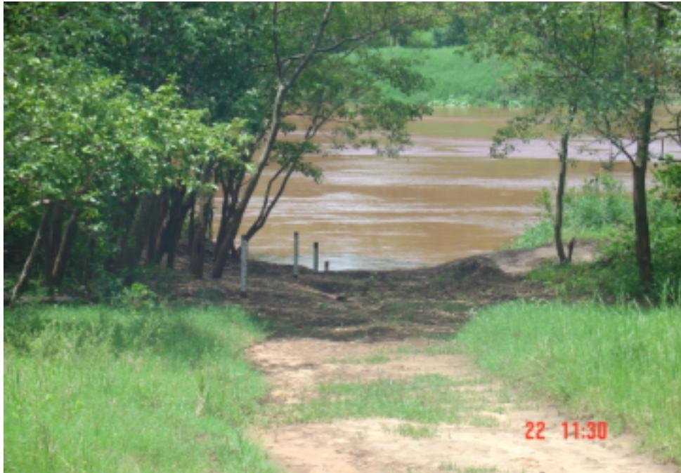
Figura 8 - Réguas para estabelecimento da elevação do leito do Rio Ivaí instaladas na estação Porto Taquara.
