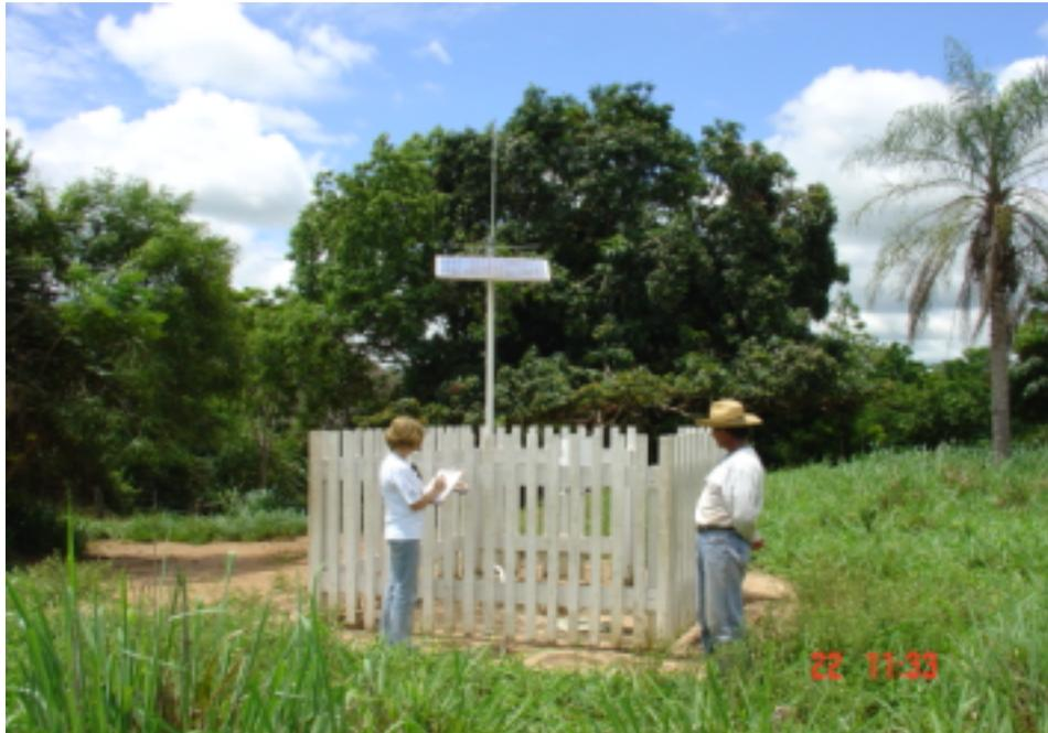
Figura 11 - Sistema de rádio transmissão dos dados obtidos em pluviômetro abastecido por sistema solar.
