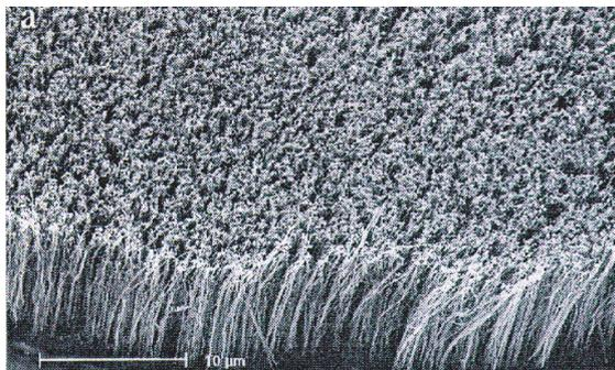
Figura 4.6: Nanotubos alinhados, normais à superfície do substrato.
