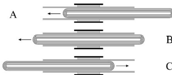
Figura 5.2: Representação esquemática, proposta por Zheng *et al* de um MWNT como um oscilador. (A) A seção do núcleo é liberada com uma extrusão inicial. (B) O núcleo é retraído inteiramente nos tubos exteriores onde a energia potencial de van der Waals é minimizada quando a energia cinética é maximizada. (C) O movimento do núcleo é invertido após a extrusão máxima à extremidade oposta dos tubos exteriores é alcançada.
