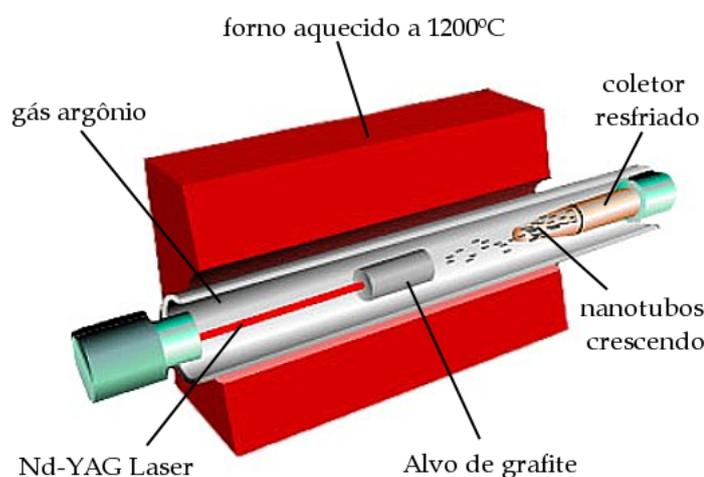
Figura 4.5: Aparato experimental do método de Ablação
