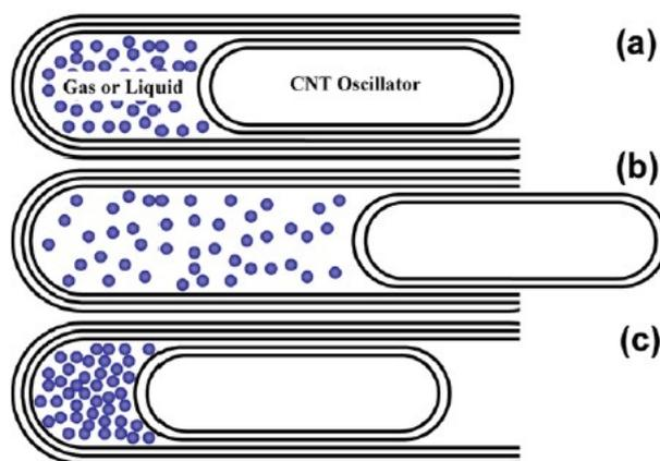
Figura 5.3: Diagrama para o oscilador de nanotubos encapsulando gás ou líquido. (a) Configuração inicial estável. (b) A energia térmica é transferida para os gases, o oscilador CNT é "empurrado" pela expansão térmica dos gases. (c) Quando o oscilador está extrudado, este sofre ação de uma força que suga o para o interior do tubo externo.
