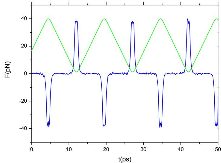
Figura 5.20: Perfil da força (azul) aplicada ao longo de  $z$  sobre o átomo de neônio no sistema Ne@CNT(5,5)-  $50\text{\AA}$ , a uma temperatura de 160K. A linha verde indica a coordenada  $z$  do átomo
