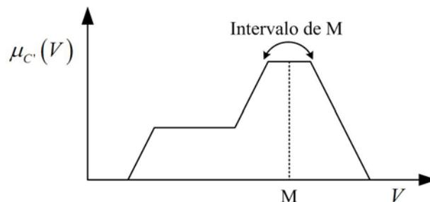
Figura 3.3 – Ilustração do método da média dos máximos.
