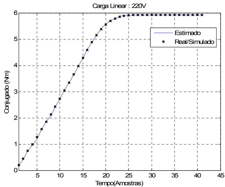
Figura 5.2 – MIT submetido a conjugado resistente linear alimentado com 220V.
