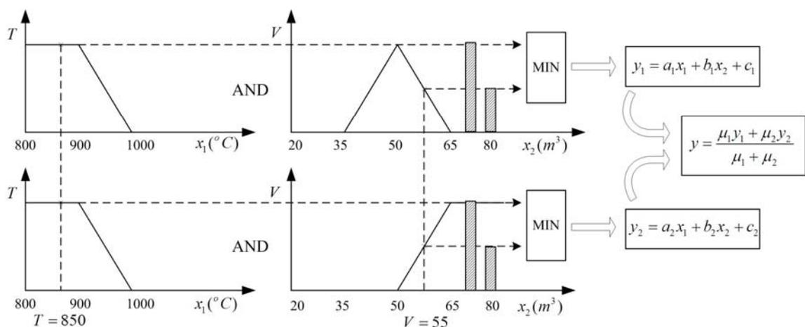
Figura 3.4 – Processos Internos ao modelo de Takagi-Sugeno.
