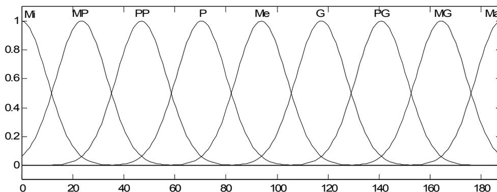
Figura 4.10 – Função de pertinência para variável linguística “velocidade”.
