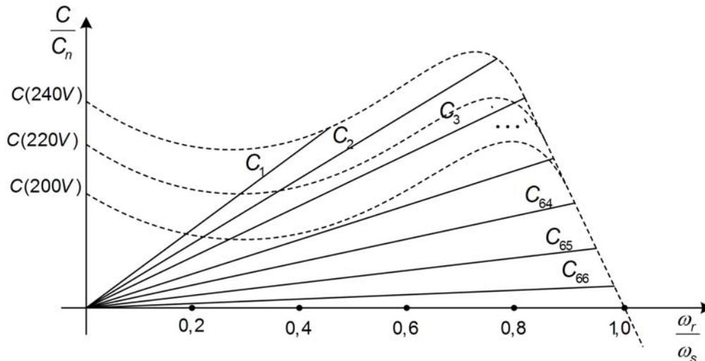
Figura 4.7 – Curva de torque para carga linear.
