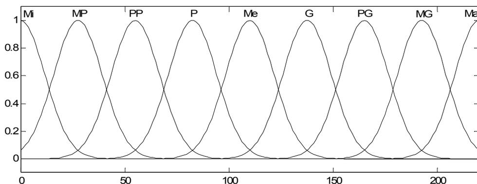
Figura 4.8 – Funções de pertinência para a tensão.
