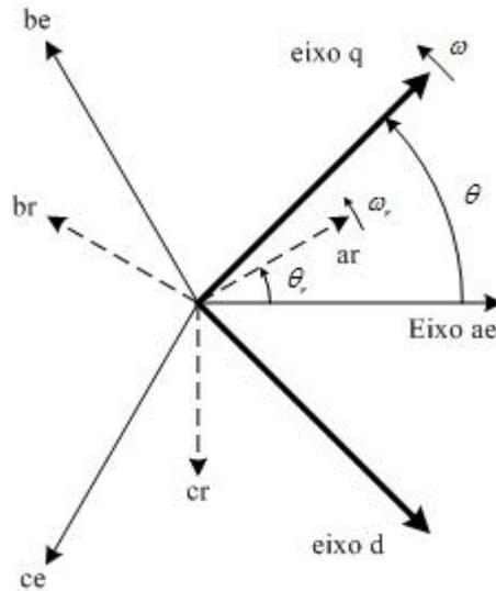
Figura 2.2 – Transformação de coordenadas.
