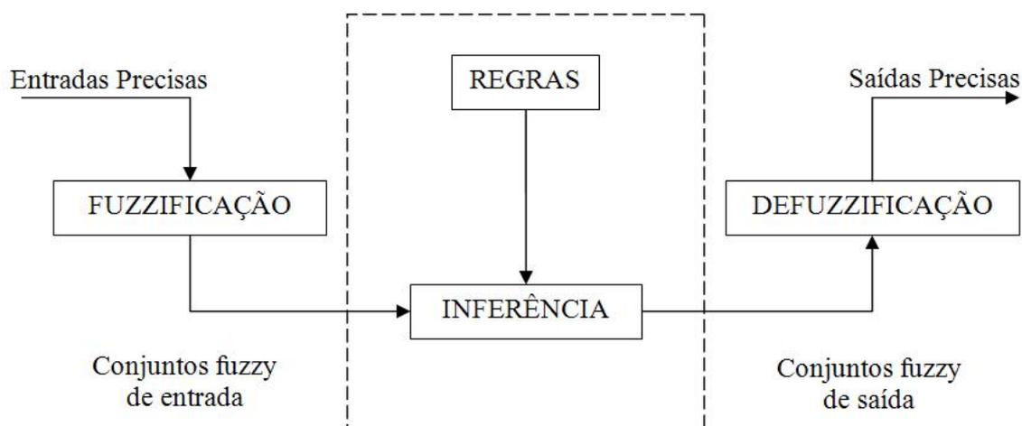
Figura 3.1 – Diagrama do processo de inferência fuzzy.
