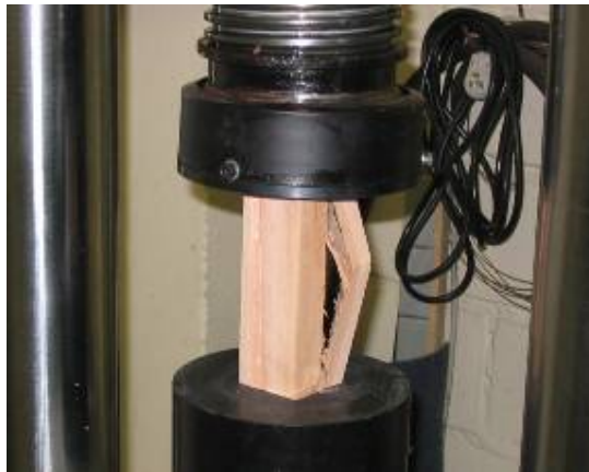
Figura 17 – Ensaio de Compressão até a ruptura, peça excluída da análise estatística por apresentar rachaduras e propriedades mecânicas inferiores.
