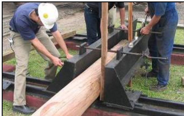
Figura 28 – Berço de engastamento: formato que contraria o recomendado pela norma de ensaios de flexão para postes.
