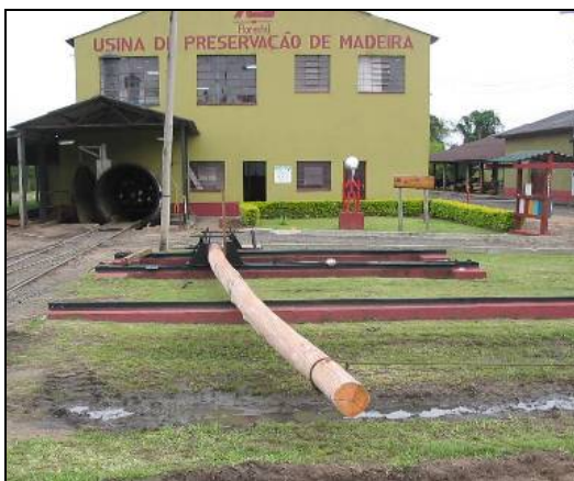
Figura 20 – Ensaio de Flexão realizado na Usina de Preservação de Madeira no distrito de Barreto.
