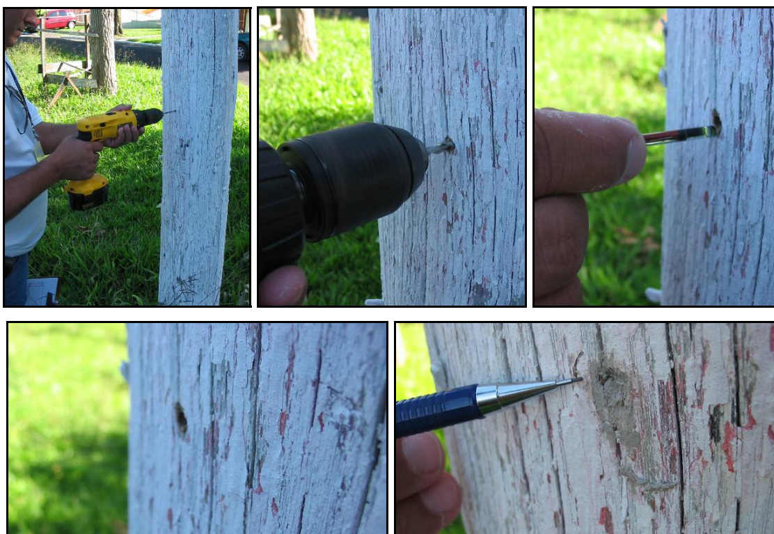
Figura 45 – Protocolo de aplicação dos TAGs nos postes de madeira.
