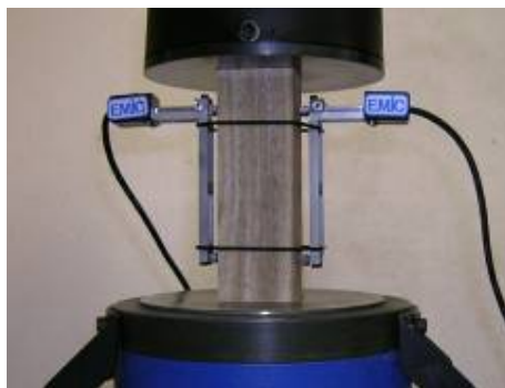
Figura 18 – Detalhe do acessório; extensômetro utilizado para aquisição da deformação da madeira nos ensaios de compressão.
