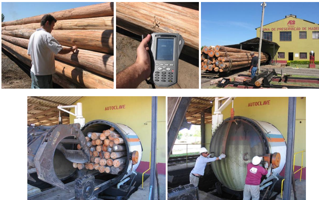
Figura 47 – Teste de resistência dos TAGs ao tratamento sob pressão de postes em autoclave.
