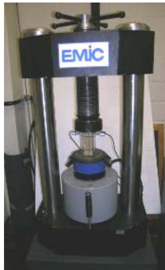
Figura 16 – Máquina utilizada para os ensaios de compressão: EMIC PC200i
