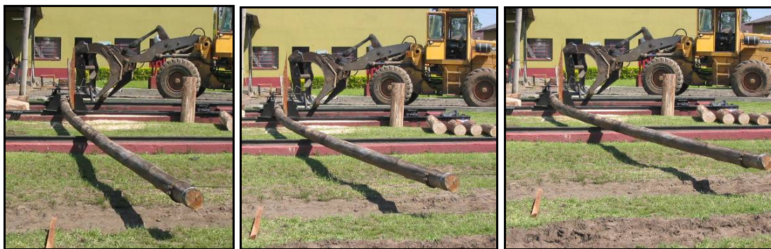
Figura 30 – Deformação do poste de Eucalyptus citriodora quando aplicada carga durante o ensaio de flexão.
