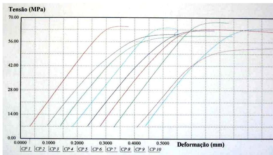
Figura 35 – Gráfico da Tensão x Deformação para corpos de prova de E.citriodora submetidos ao ensaio de compressão paralela às fibras.
