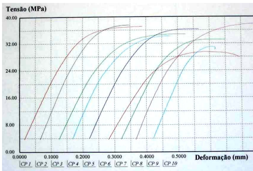
Figura 34 – Gráfico da Tensão x Deformação para corpos de prova de E. saligna submetidos ao ensaio de compressão paralela às fibras.
