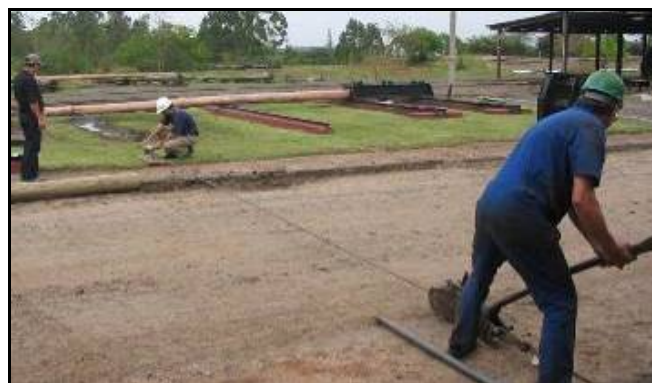
Figura 29 – Aplicação de carga manual, ignorando as recomendações de aplicação de carga constante da norma de ensaio de flexão para postes.
