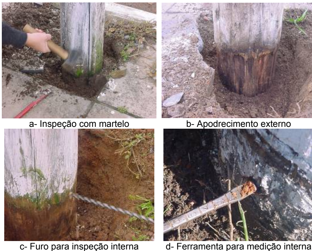
Figura 22 – Fotos mostrando as diferentes etapas de um procedimento de inspeção dos postes em campo.
