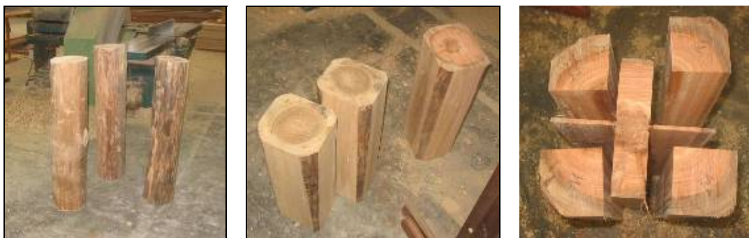
Figura 13 – Técnica de obtenção dos corpos de prova para os ensaios de compressão.
