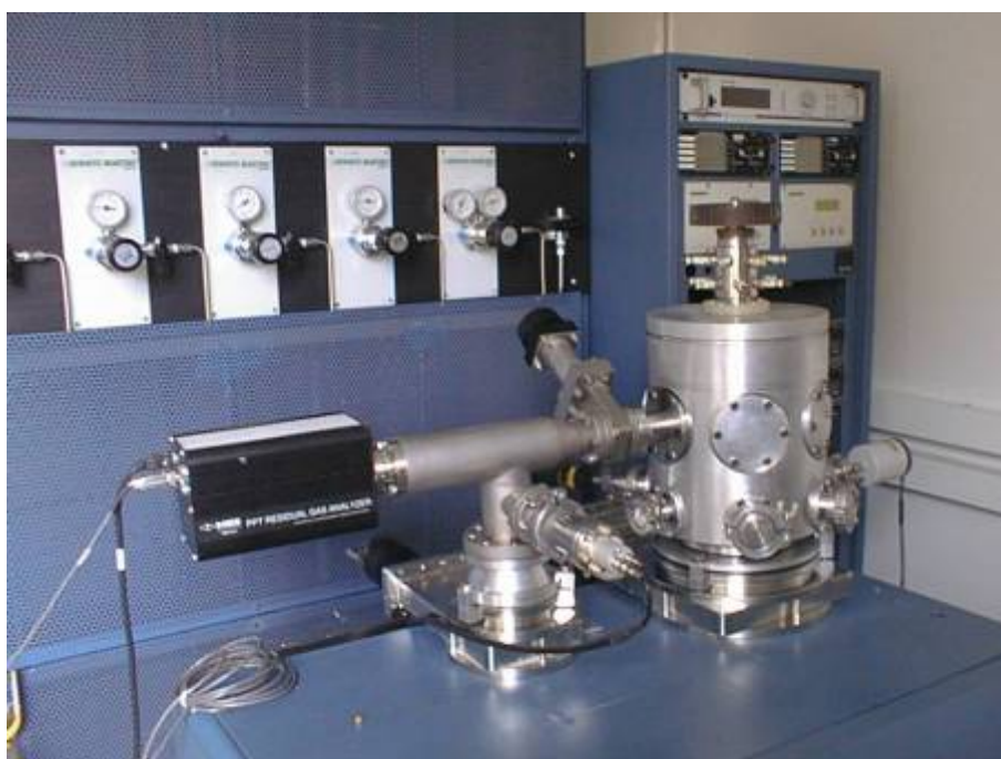
Figura 12: Equipamento de deposição tipo Magnetron Sputtering onde foi realizada a deposição dos filmes finos de titânio nas amostras de UHMWPE.
