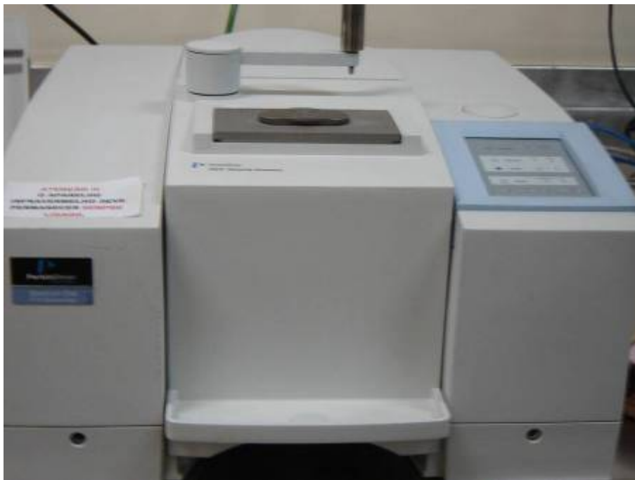
Figura 16: Mostra o equipamento utilizado para as análises de FTIR.
